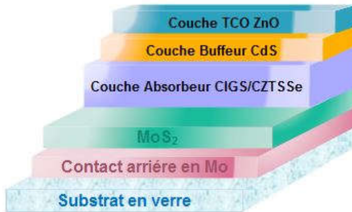
Figure V. 1 : Structure de la cellule solaire au CIGS ou CZTSSe.
