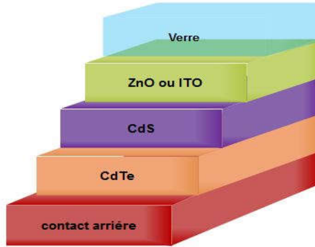
Figure I. 9 : Structure d'une cellule photovoltaïque au CdTe.
