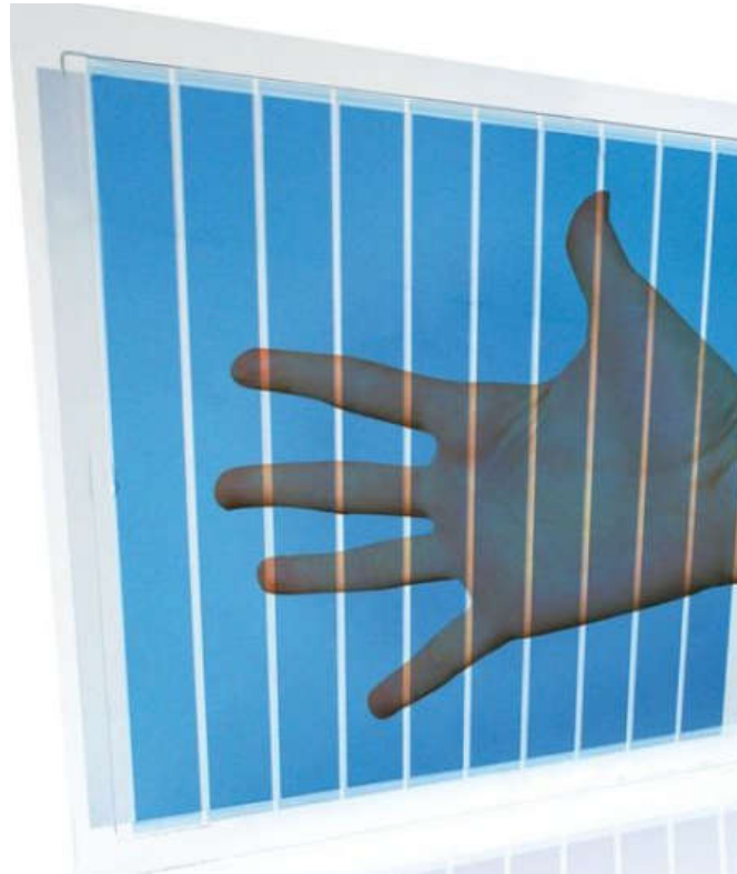
Figure I. 11 : Cellules solaire organique transparente [40].
