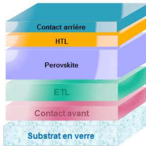
Figure V. 11 : Structure de la cellule solaire de type pérovskite.
