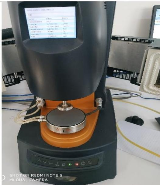
**Figure II.9.** Rhéomètre discovery TA instrement, mode plan-plan ; (Laboratoire Macromolécules LRM).
