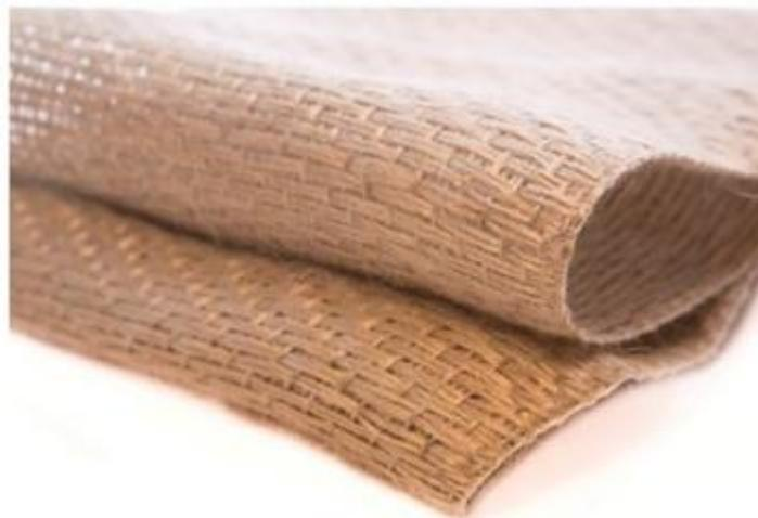
**Figure I.8.** Lin de fibre tissé avec matrice PLA, PP et PA
