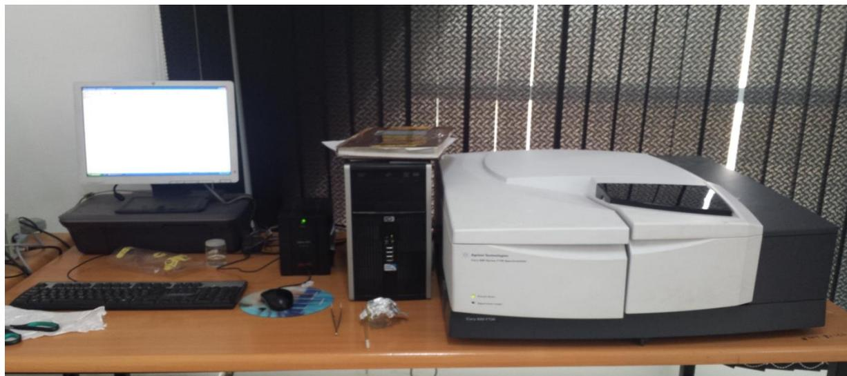
**Figure 2.5 :** Spectroscopie Infrarouge à Transformée de Fourier (FTIR).
