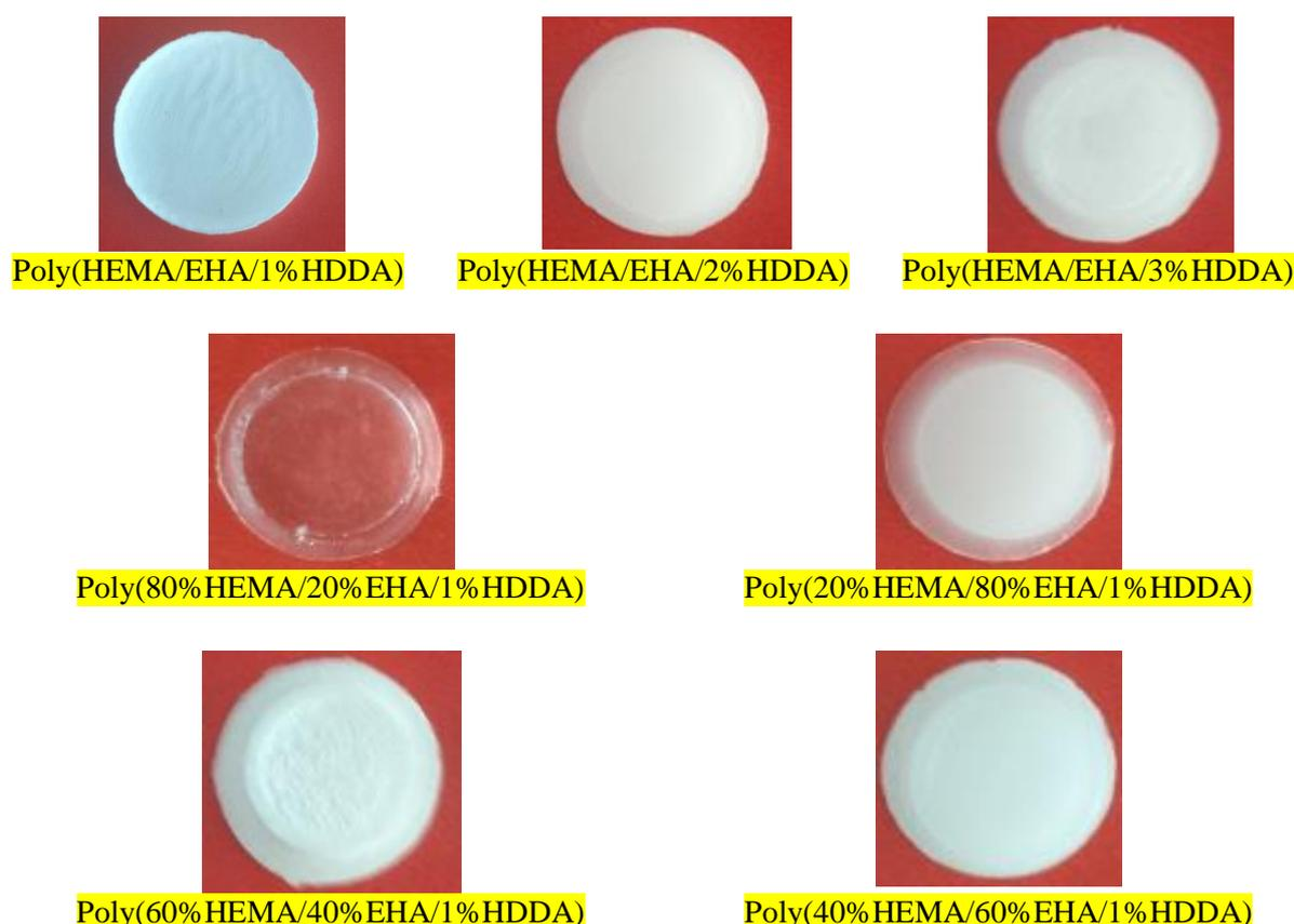
**Figure 2.4 :** Réseaux de copolymères élaborés par photo polymérisation (pastilles).
