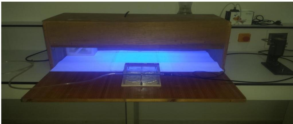
Figure 2.2 : Dispositif de photo polymérisation UV.
