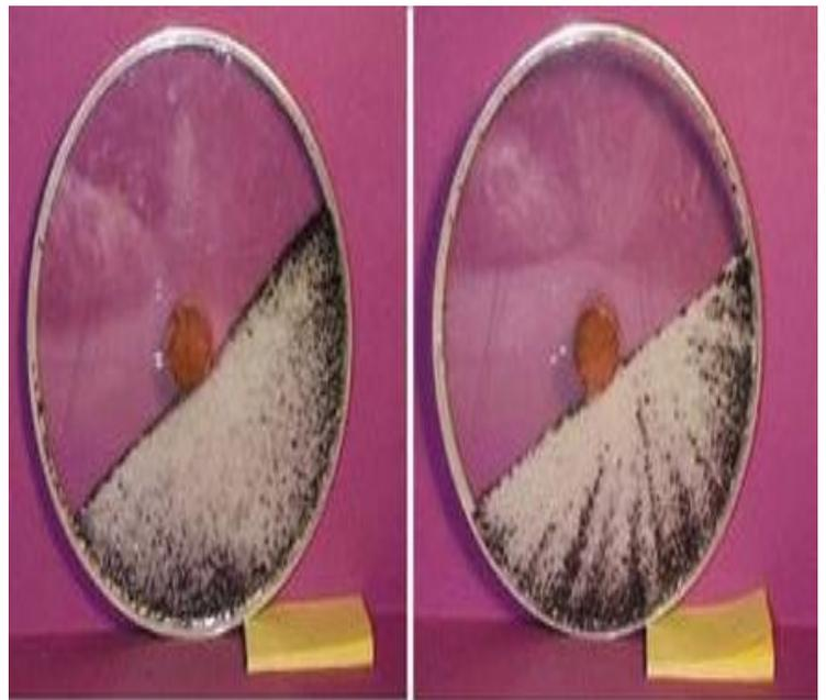
Figure I-9 : ségrégation en tambour tournant [f-9]
