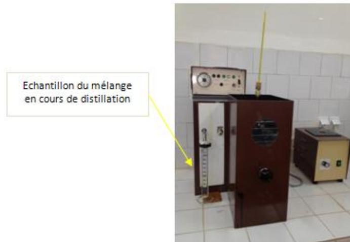
Fig. 2. 11 Distillateur atmosphérique du laboratoire
