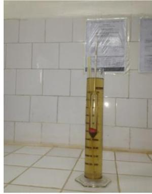
Fig. 2. 10 Prise de Masse volumique et de température d'un échantillon du mélange par l'aréomètre
