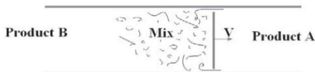
Fig. 1. 5 Disque de séparation générée par la turbulence
