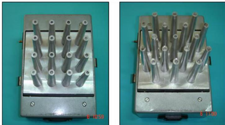
**Figure I.32** Dissipateurs coniques [48]
