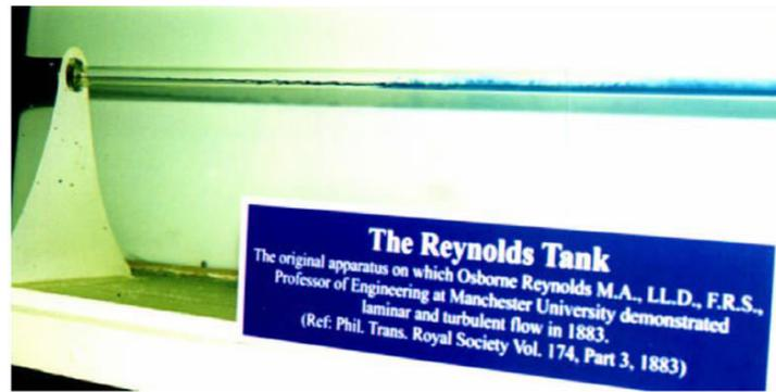
**Figure II.8** Vue globale du système utilisé par Reynolds.
