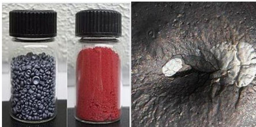
**Figure I.15 :** a) Deux sélénium amorphes : forme noire et vitreuse compacte (avec parfois une fine couche de Se gris métal qui se forme lentement au-dessus de 13 °C) et forme rouge fine, poudreuse ou floconneuse (à gauche).
