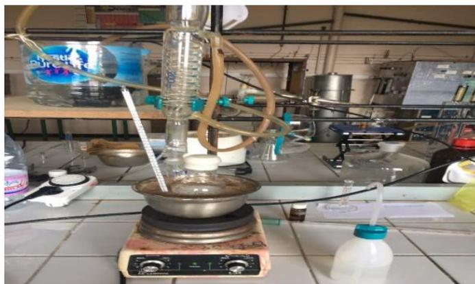
**Figure 7** : Montage du test catalytique sur l'oxydation du cyclohexène
