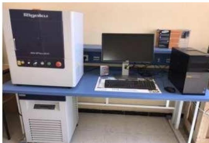
Figure II.3. Appareil DRX « Rigaku MiniFlex 600 »
