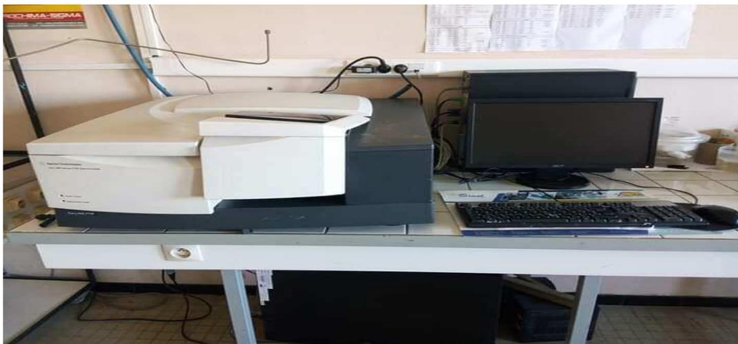
**Figure II.4 :** Appareil du spectromètre Infrarouge à Transformée de Fourier (IRTF)
