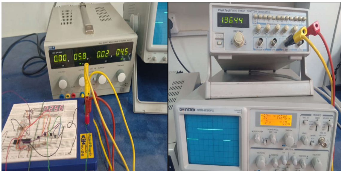
Figures III.20: Photos réelles de l'affichage digital à base de pic 16F876A
