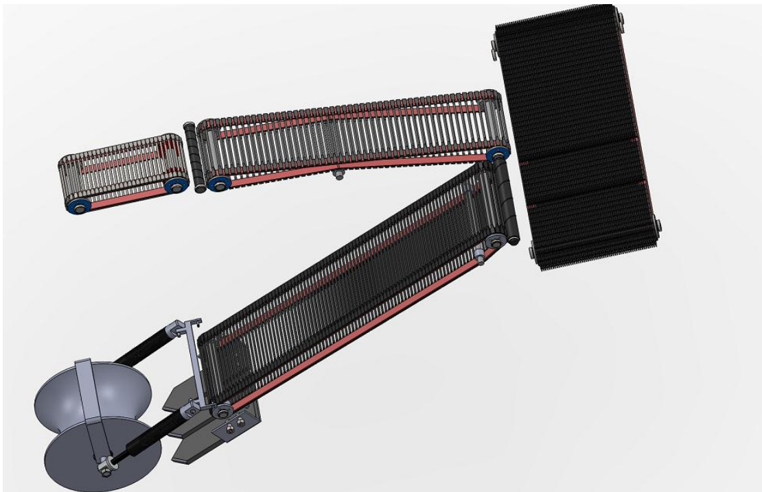
Figure IV.7 : Vue de profil de machine arracheuse ramasseuse de pomme de terre
