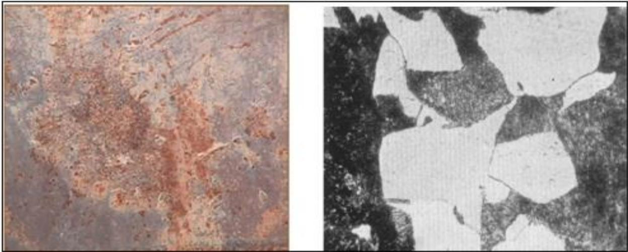
*Figure III.3 microscopies sur un acier corrodé*
