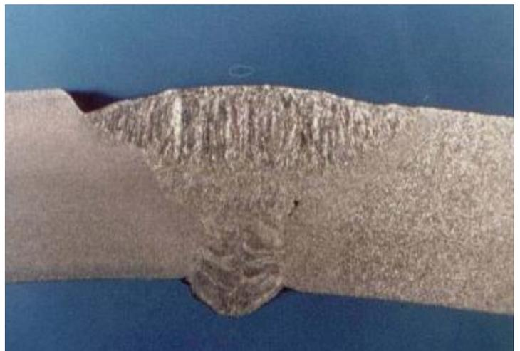
*Figure 2.12. Caniveau en surface de joint soudé.*
