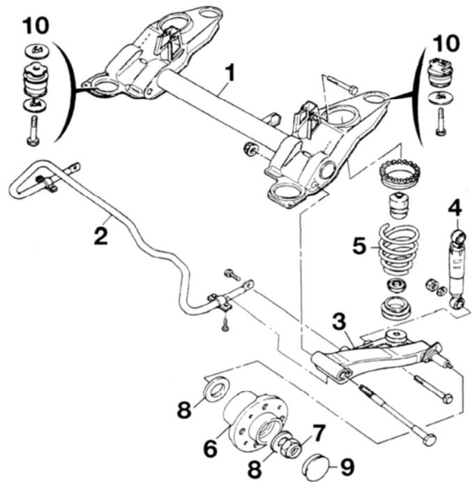
**Figure 3.14** Eléments du train arrière [3]
