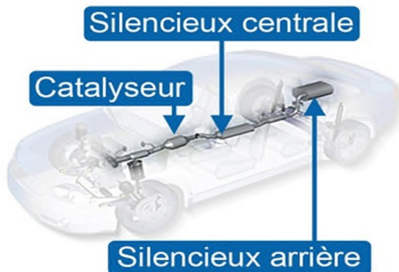
**Figure 3.23** Canalisation d'échappements.
