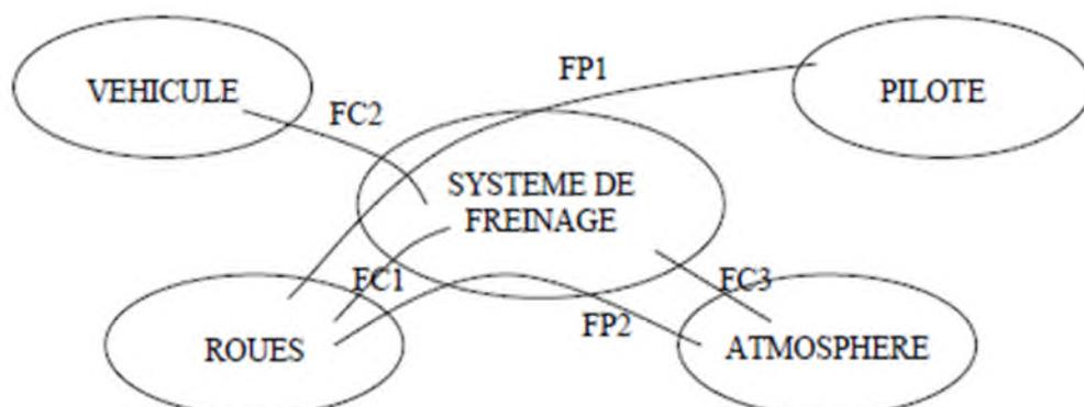
Figure 4.7 : Environnement du système de freinage [19]
