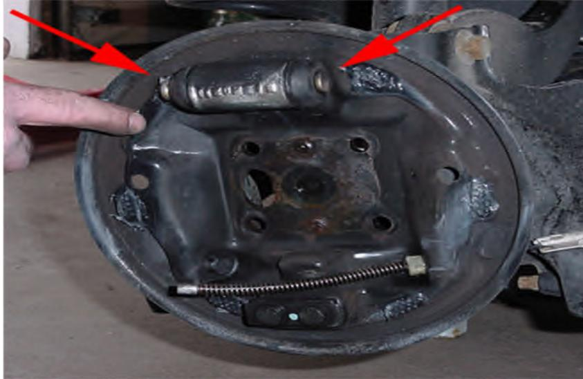
**Figure 4.14 :** Dépose du tambour (visibilité d'huile) [20]
