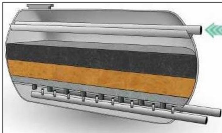
**Figure 2-10 : Module de filtration à sable et anthracite**
