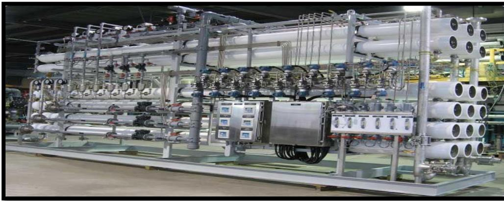
**Figure I.11** : Association des tubes de pression d'une manière modulaire [5].
