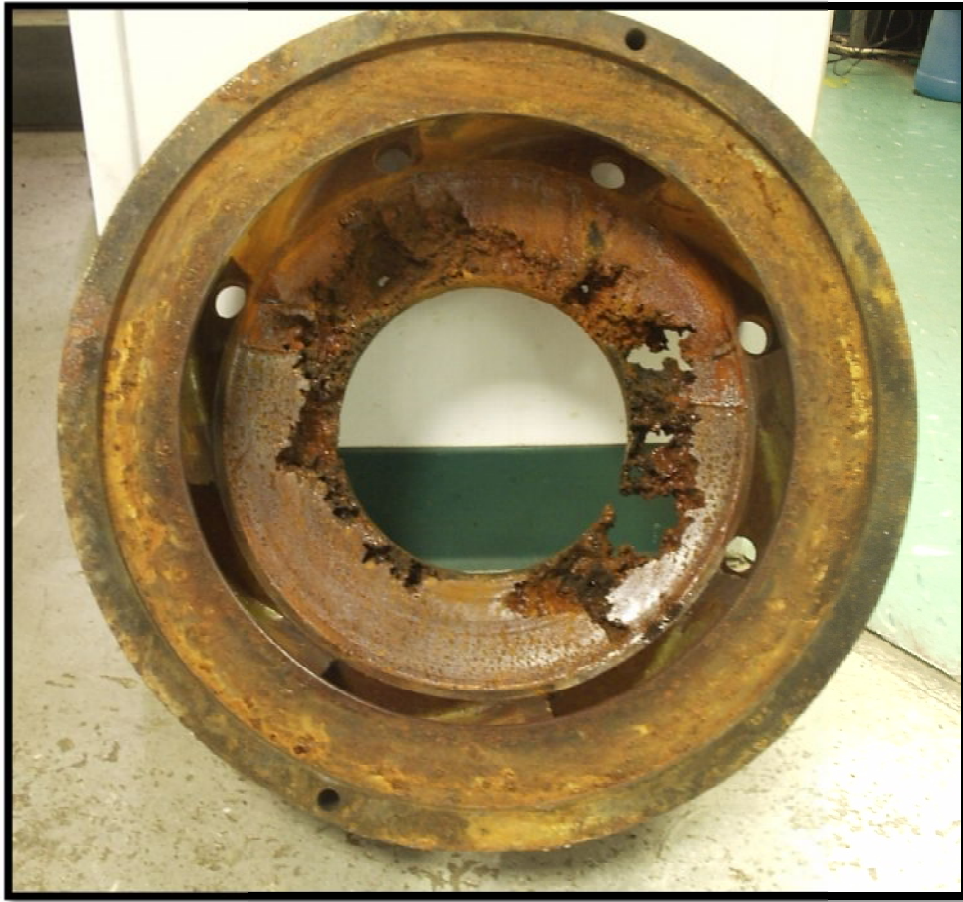
Figure III.1: Photo illustrant la cavitation sur un impulseur
