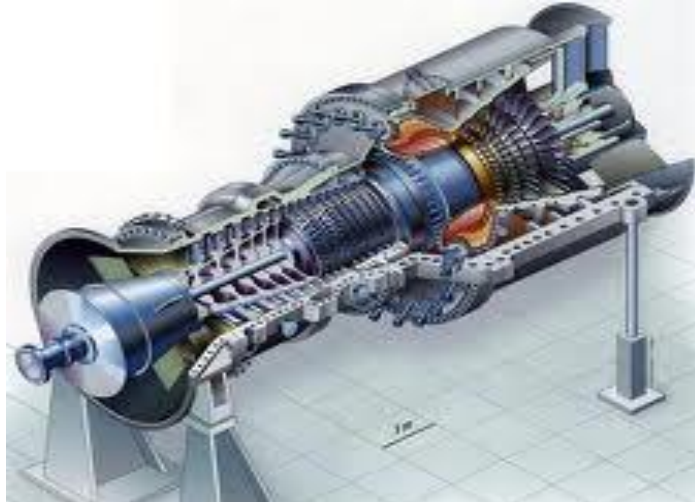
Figure 1.2 : Turbine à gaz.
