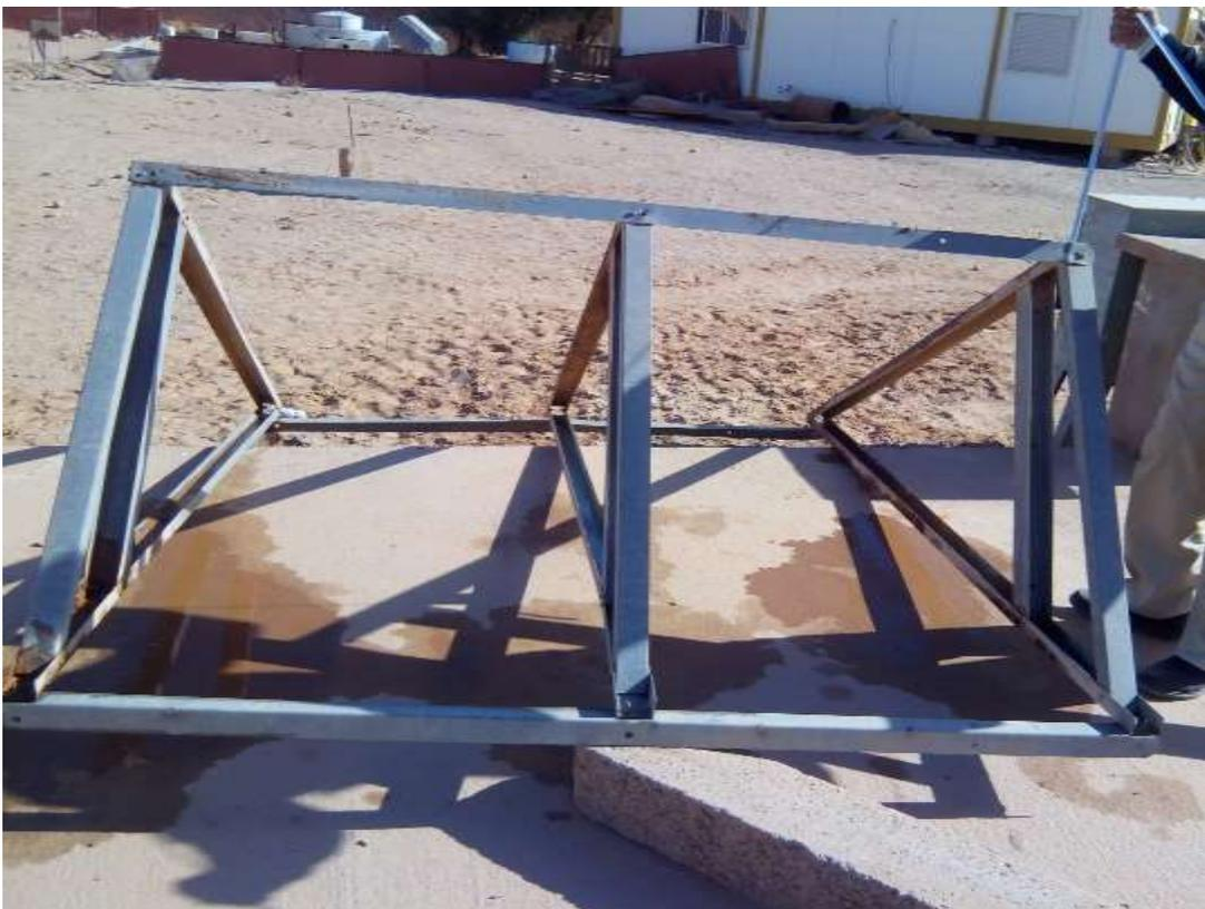
*Figure IV 8. Support de fixation du capteur solaire plan*
