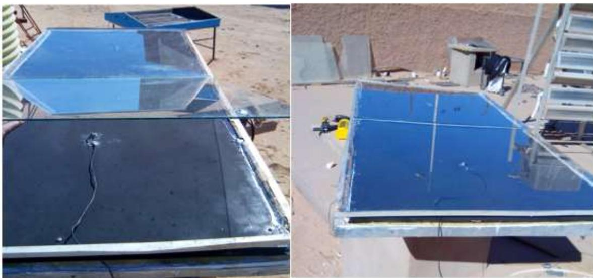
*Figure IV 6 Placements de thermocouples et les deux moitiés des vitres*
