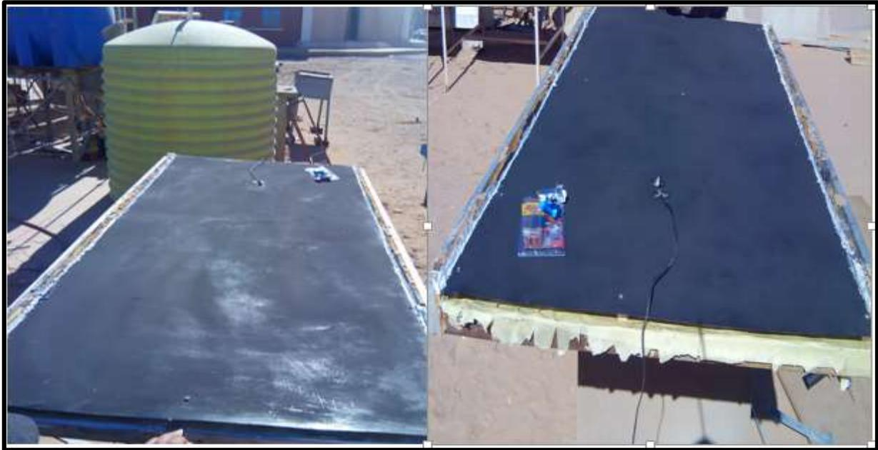
*Figure IV 5 Placement de thermocouple sur l'absorbeur*
