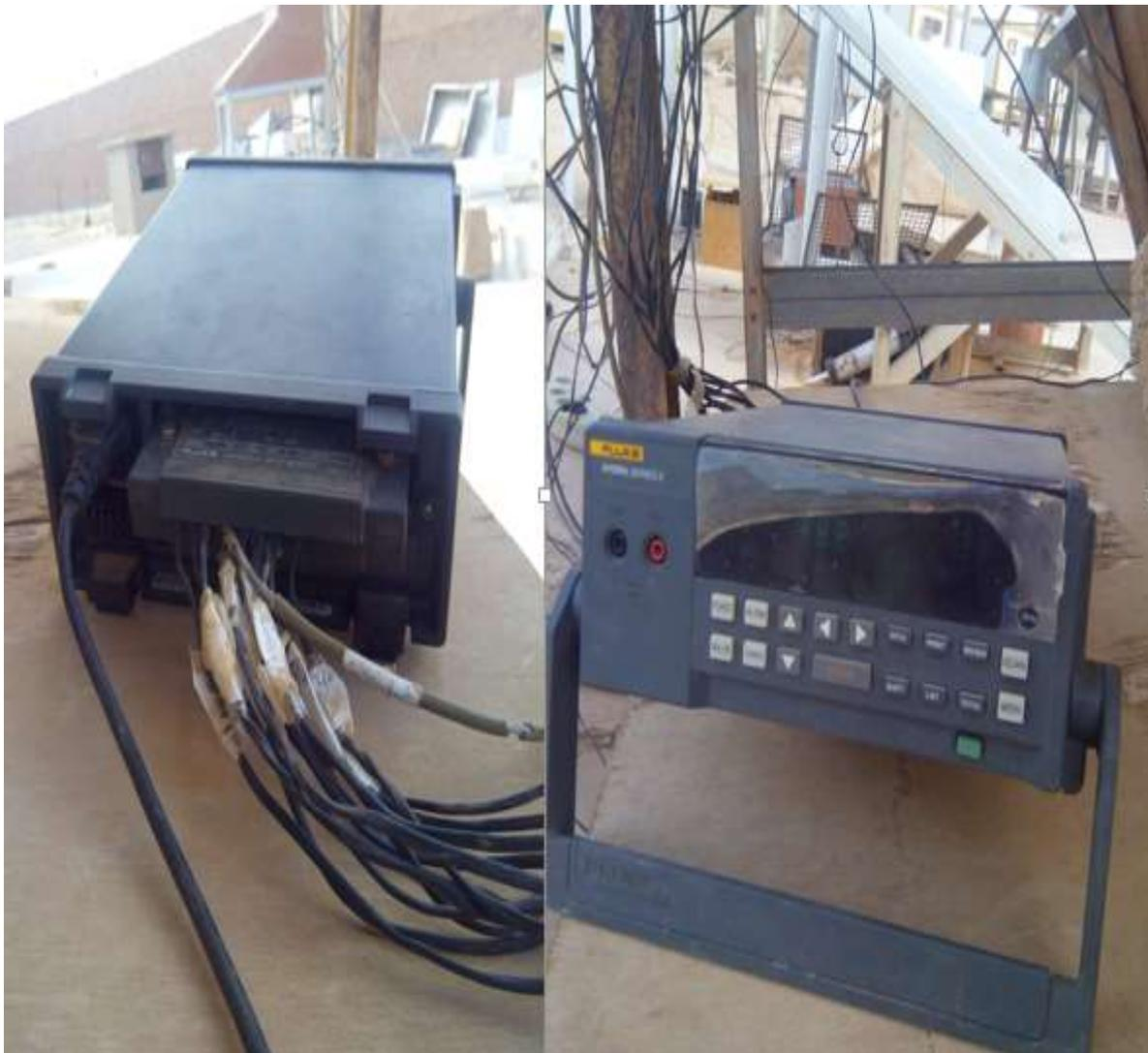
*Figure IV 11. Appareil "acquisition de données" avec raccordement de différents thermocouples*
