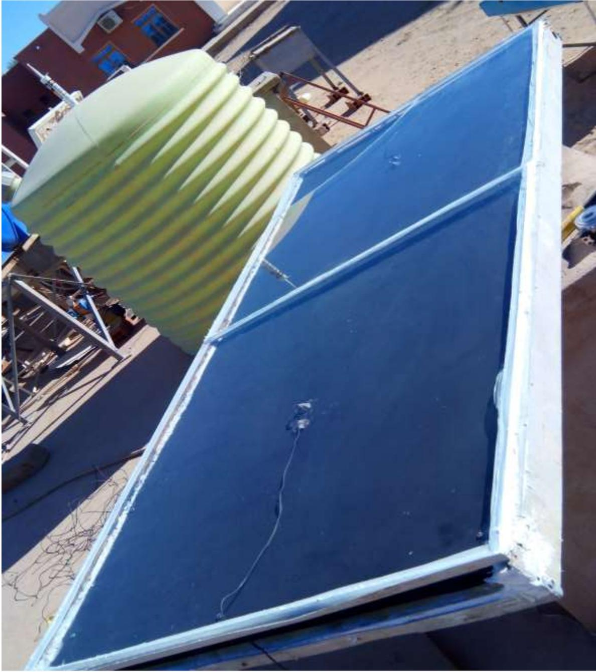
*Figure IV 7. Montage du capteur*
