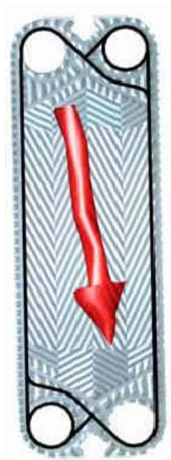
Figure II.9: La circulation des fluides est diagonale
