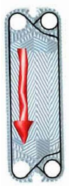
Figure II.8: La circulation des fluides est latérale
