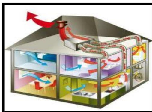
Figure 17 : VMC simple flux
