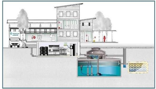
Figure 118 : système de récupération des eaux pluviales
