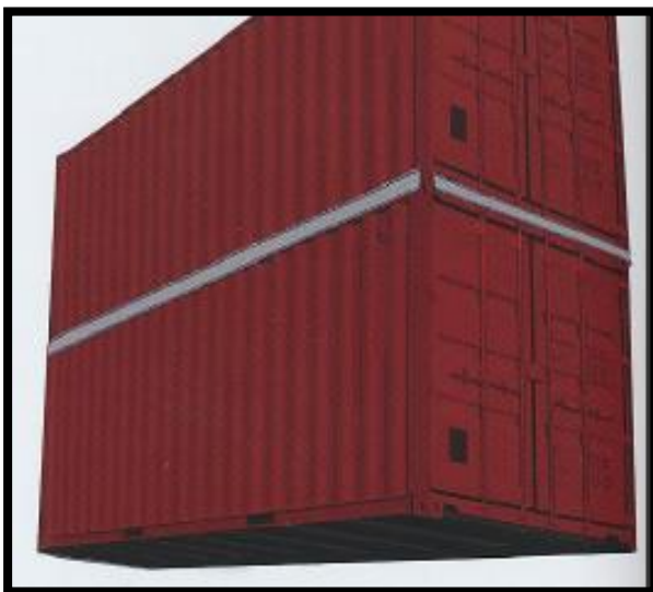
Figure 93 : soudure entre 2conteneurs Source: Construire sa maison container, éditions Eyrolles 2011, p70
