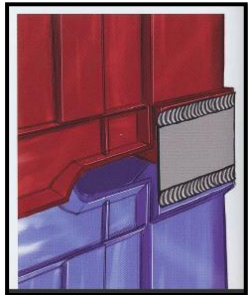
Figure 94 : la soudure de conteneurs Source: Construire sa maison container, éditions Eyrolles 2011, p70
