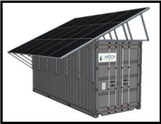
Figure 102 : disposition des panneaux solaires sur un conteneur
