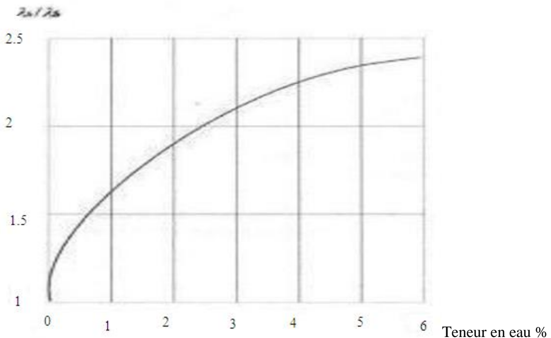
Figure II-11 : Variation du rapport des conductivités pour le béton d'agrégats de quartzite \rho=2200(\text{kg/m}^3) .
