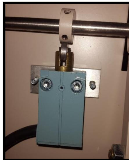
Figure II. 7 : Capteur de sécurité.
