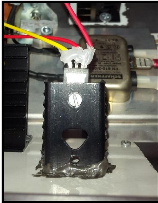
Figure IV. 5 : Ailette placée avec transistor.
