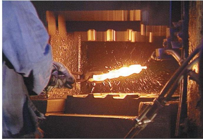
Fig. 8: Opération forgeage[11]
