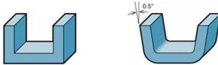
Fig. 6: Moule sans et avec dépouille[44]
