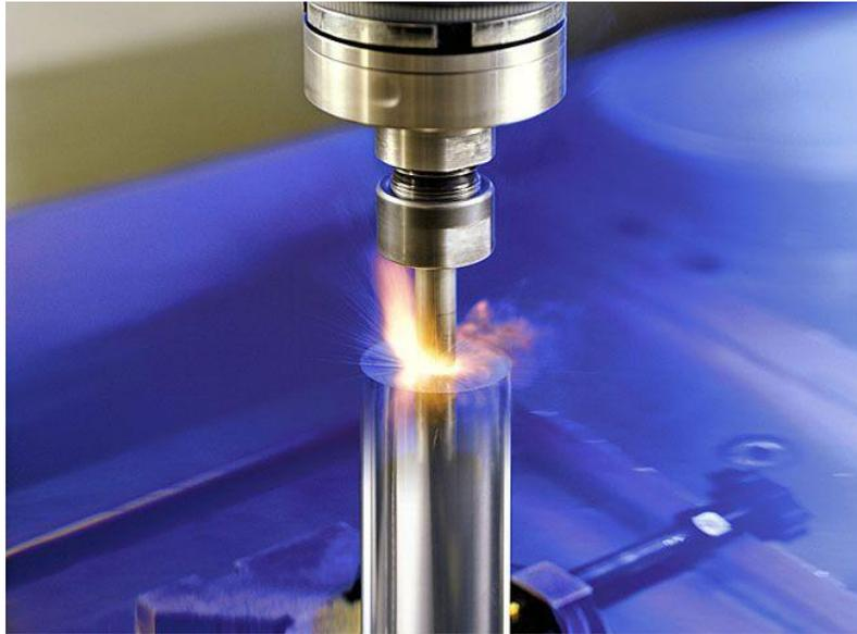
Fig. 20: Opération d'électroérosion[32]
