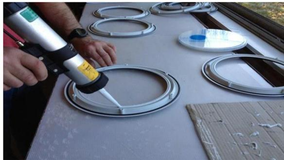
Fig. 16: Assemblage par collage[25]
