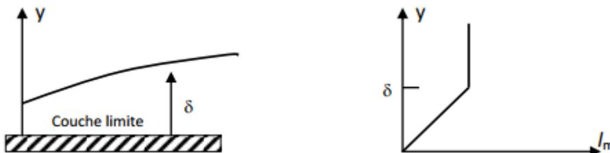
Figure I.8- Longueur de mélange dans une couche limite
