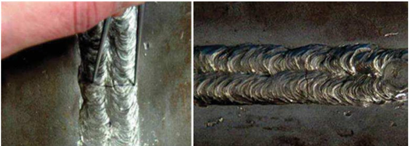
Figure III.2 : La fissure transversale.
