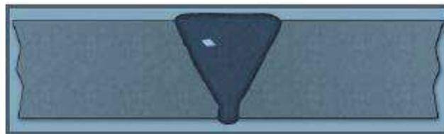
**Figure III.17:** Inclusions de cuivre.***B- Causes possibles :***
