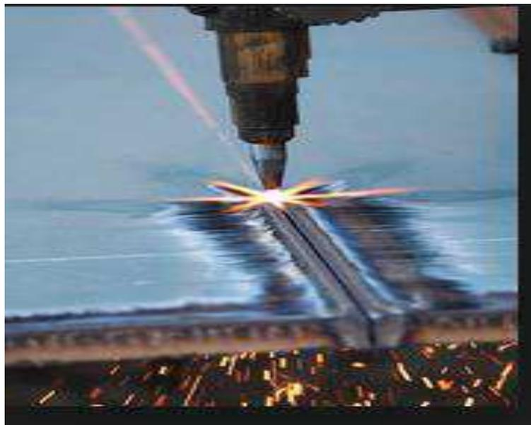
**Figure II.11** : Soudage laser.
