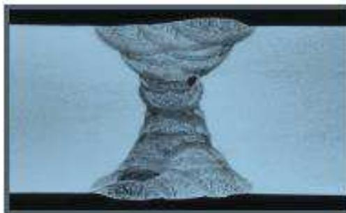
**Figure III.15:** Inclusions de laitier.
