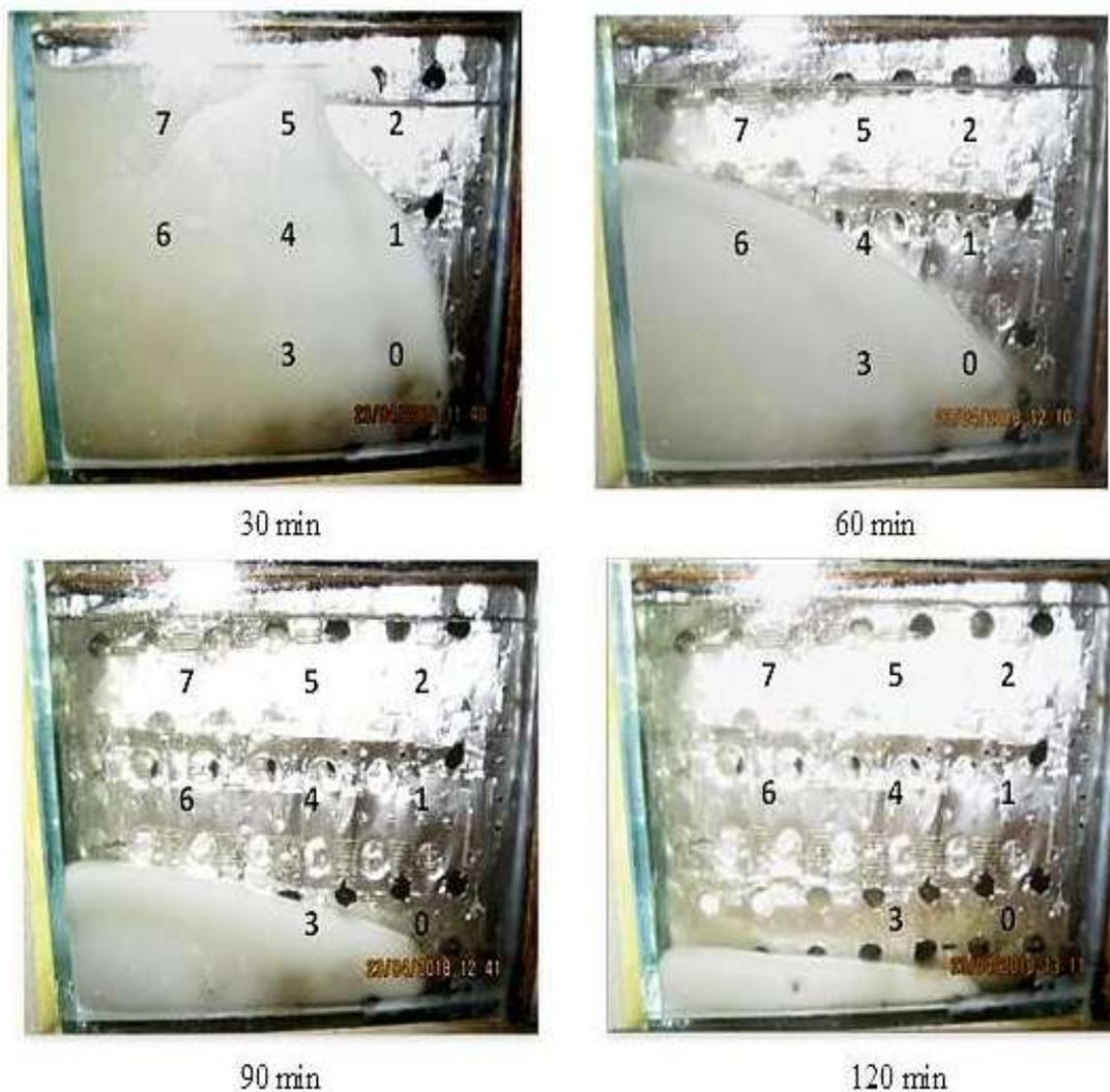
**Fig. II.16. Evolution temporelle de la fusion de la paraffine avec une grille en l'aluminium [23].**
