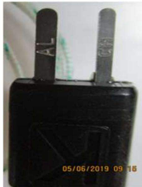
b. Capteurs type K avec têtes plates utilisées aux expériences.
