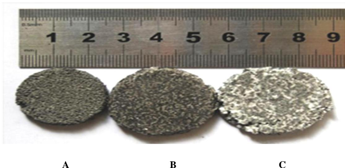
**Fig. I.8. Illustration de trois échantillons de mousse en aluminium. (A) mousse seule, (B) mousse imprégnée de paraffine et (C) mousse imprégnée d'acide stéarique (MCP) [10].**
