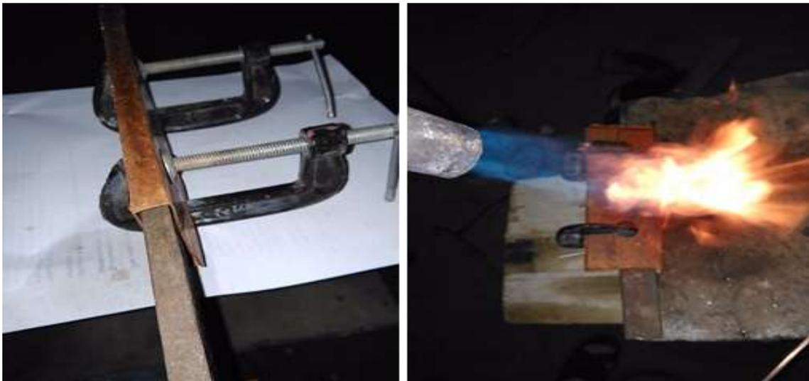
Fig. III.5. Pliage et soudage des tôles en Cu.
