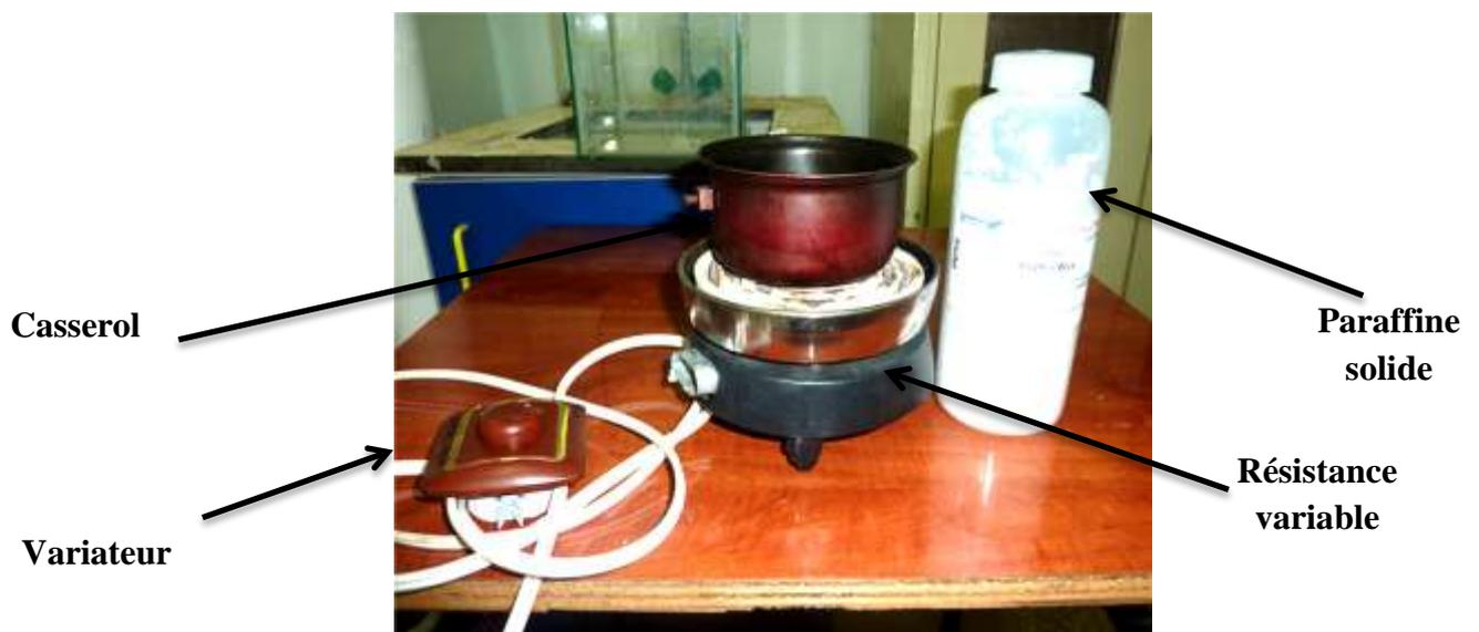
**Fig. III.10. Méthode de chauffage de la paraffine.**
