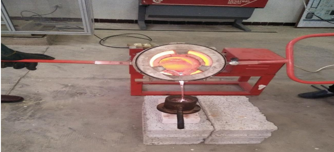
Fig.IV.11 : coulée de l'aluminium.
