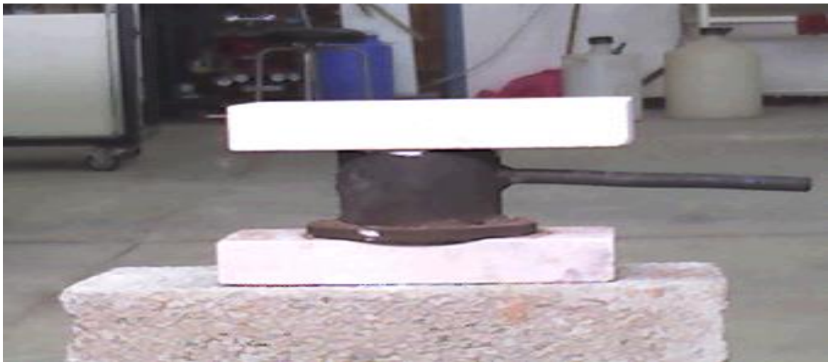
Fig.IV.19 : Moule poteyé ferme avec une brique.
