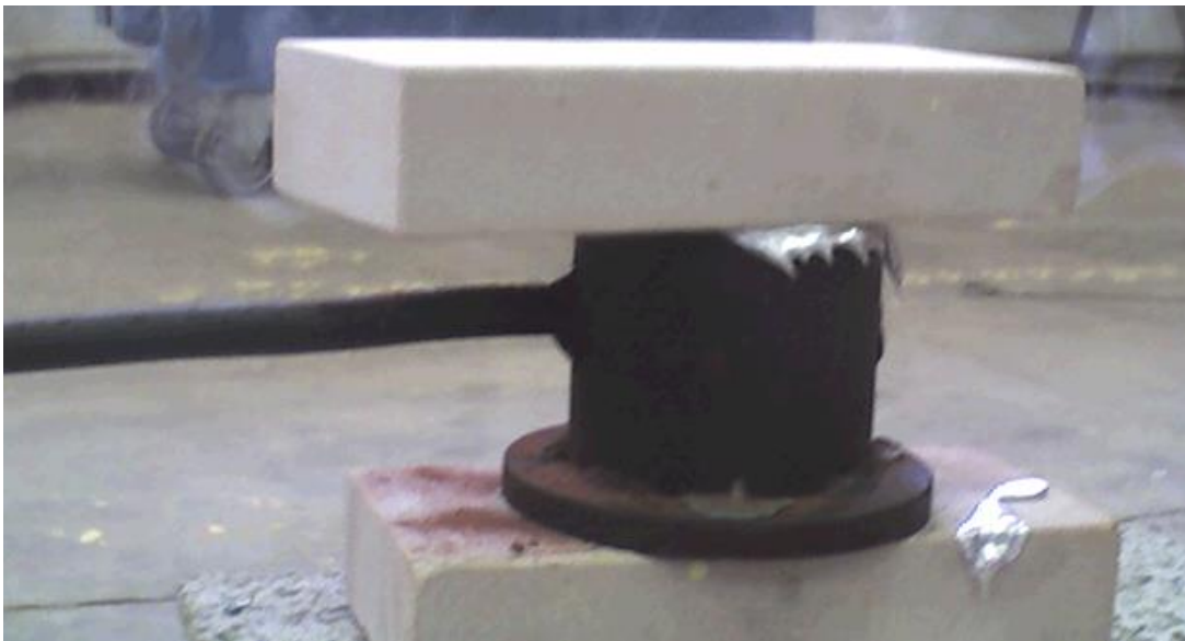
Fig.IV.12 : Moule ferme avec une brique.
