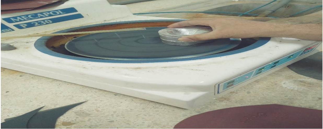
Fig.IV.23 : Polissage des pièces.
