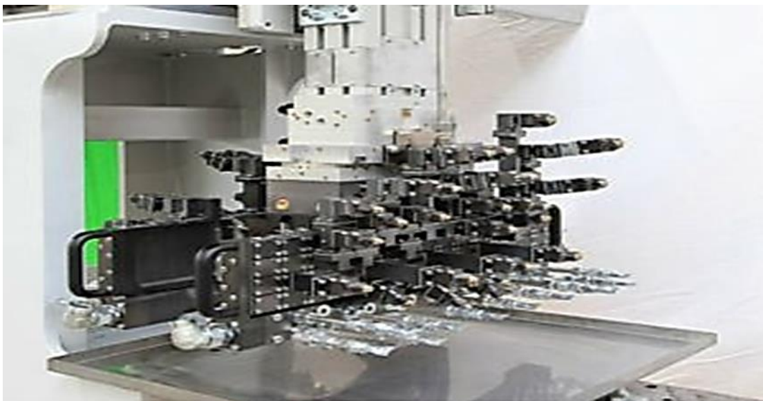
Fig. II.8 : Poteyage avec grand nombre de buses [21].
