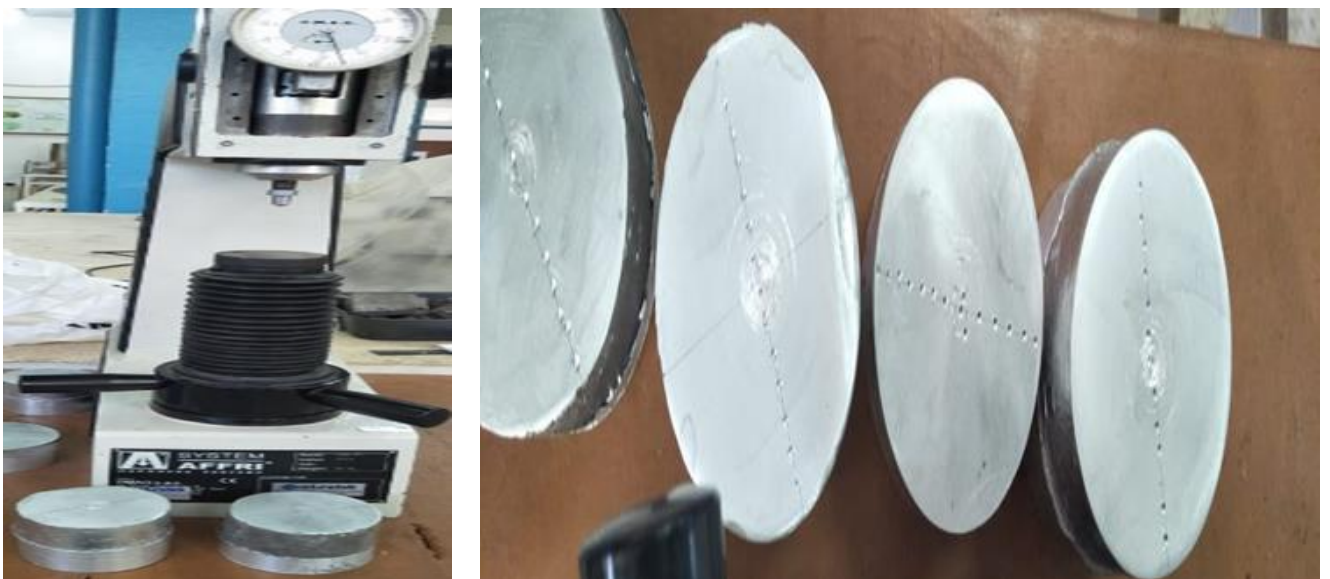
Fig.IV.24 : Essai de dureté des pièces finis.
