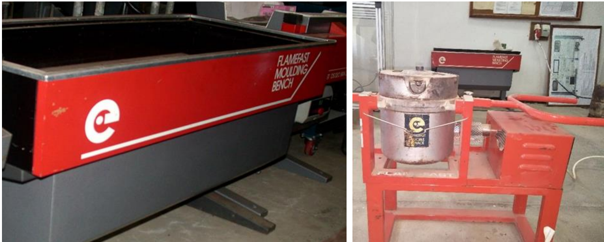
Fig.IV.8 : Banc de moulage avec le creuset.
