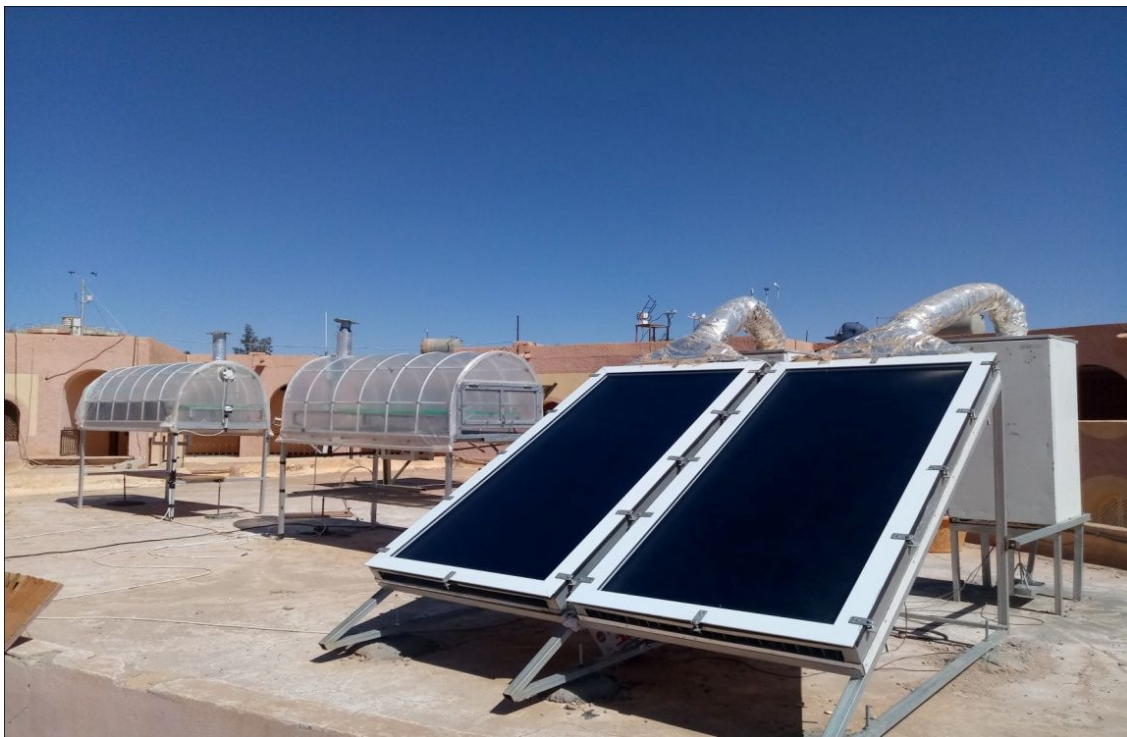
Figure III.9 Prototype réalisé pour le séchage de la courgette et la betterave.
