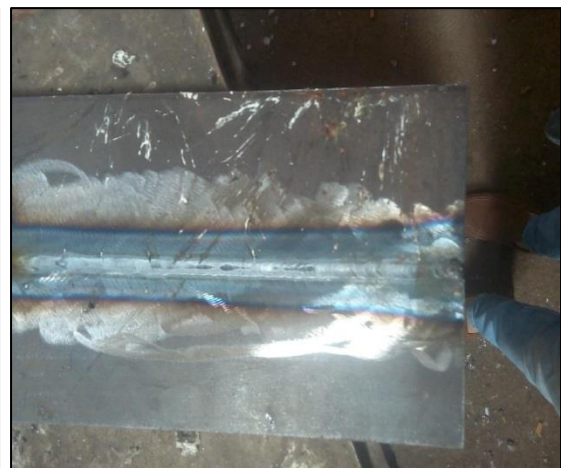
Figure4.5 : tôles après soudage TIG.
