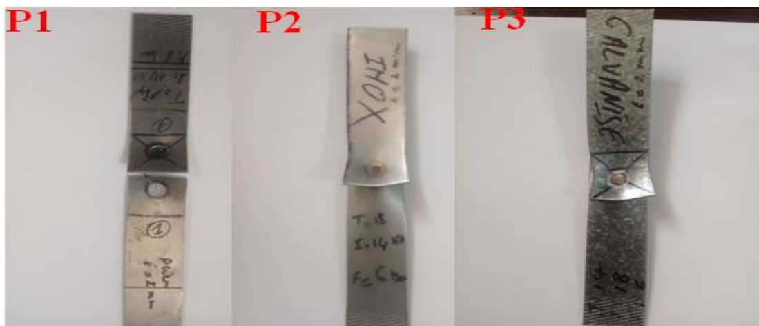
Figure (V.1) : Les éprouvettes rompues après l'essai de traction pour différents types de matériaux
