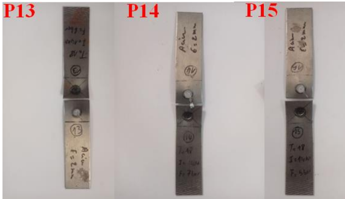
Figure V.15 Eprouvettes rompues après l'essai de traction pour I=14 KA, T=18 Cycle.
