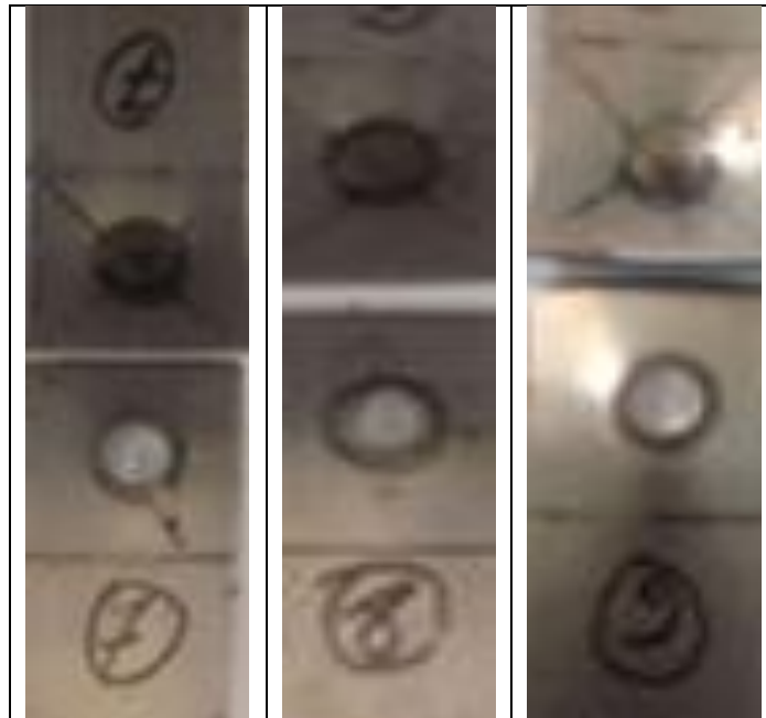
Figure V.11 : Influence de l'intensité du courant sur le diamètre final (Acier doux et de la charge entre les électrodes F=6 Bars, e = 2mm et T=18 cycles)
