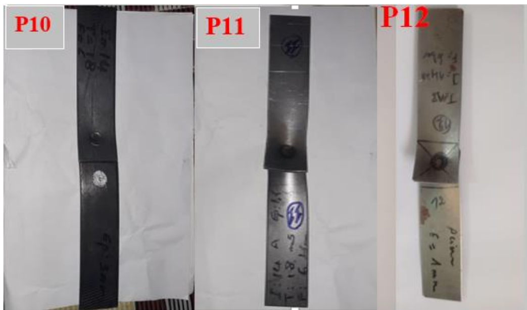
Figure V.12 : Eprouvettes rompues après l'essai de traction pour I=14\text{ KA} , T=18 Cycle, et F=6\text{ Bars}
