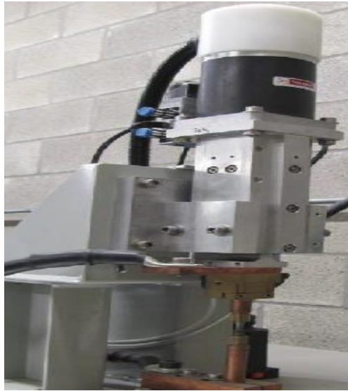
Figure II.2 : soudeuse par points disponible au Cewac[15]
