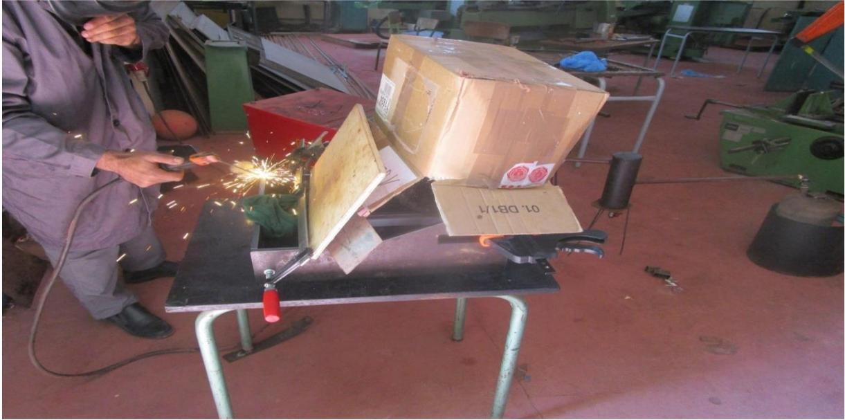
**Figure 4.12 : soudage des pièces de bâti**
