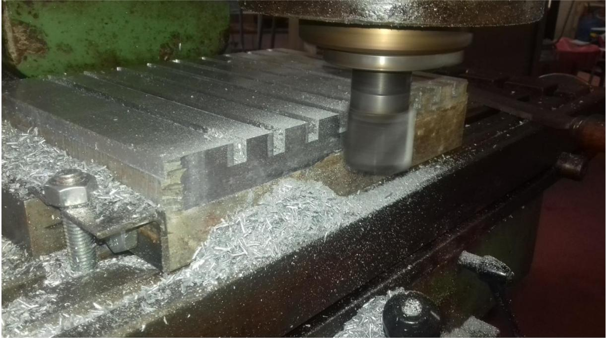
**Figure 4.18 : surfaçage des côtés de la table**
