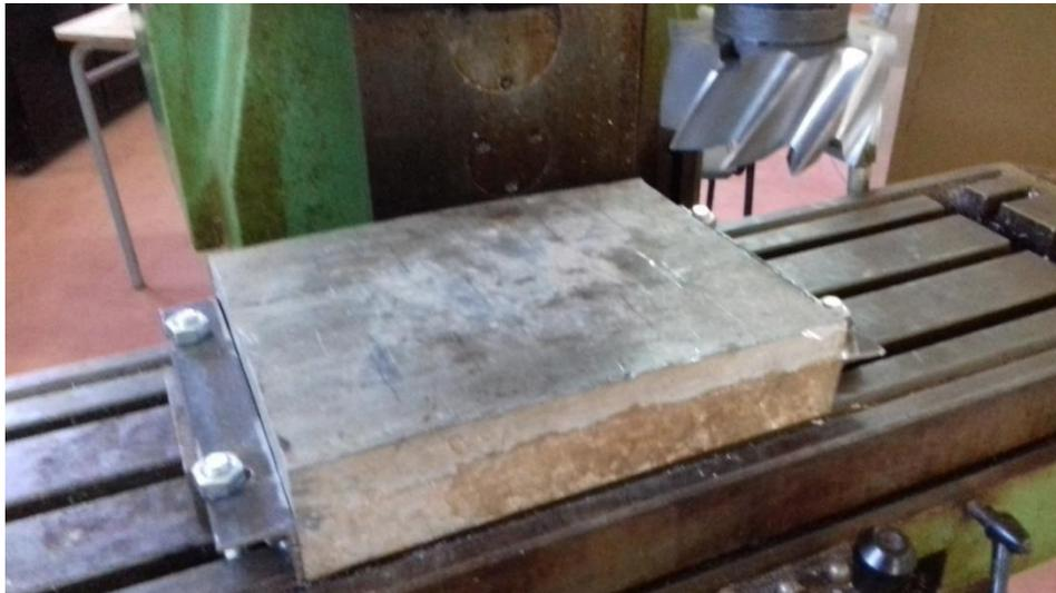
**Figure 4.15 : montage du brut dans la fraiseuse**
