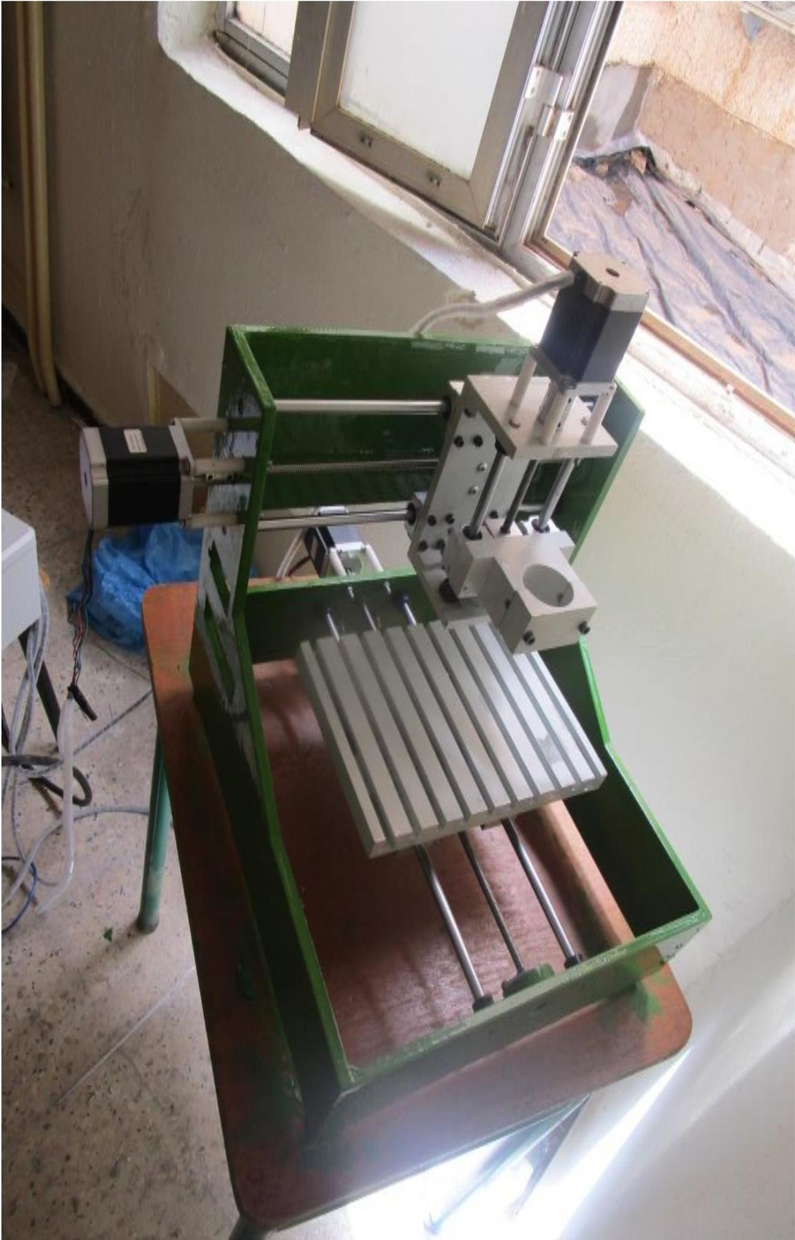
Mini fraiseuse CNC à 3 axes
