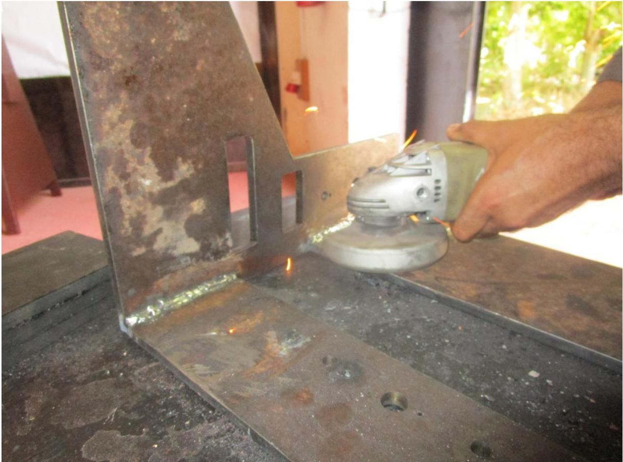
**Figure 4.13 : la finition des joins de soudure**
