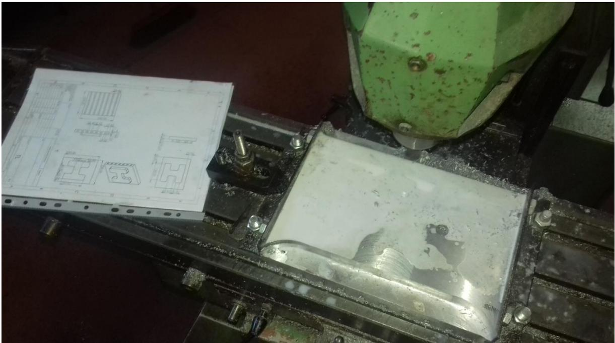
**Figure 4.19 : l'usinage d'autre face de la table**
