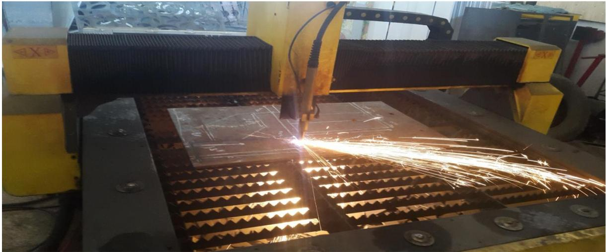
**Figure 4.10 : la découpe par plasma des pièces de bâti**
