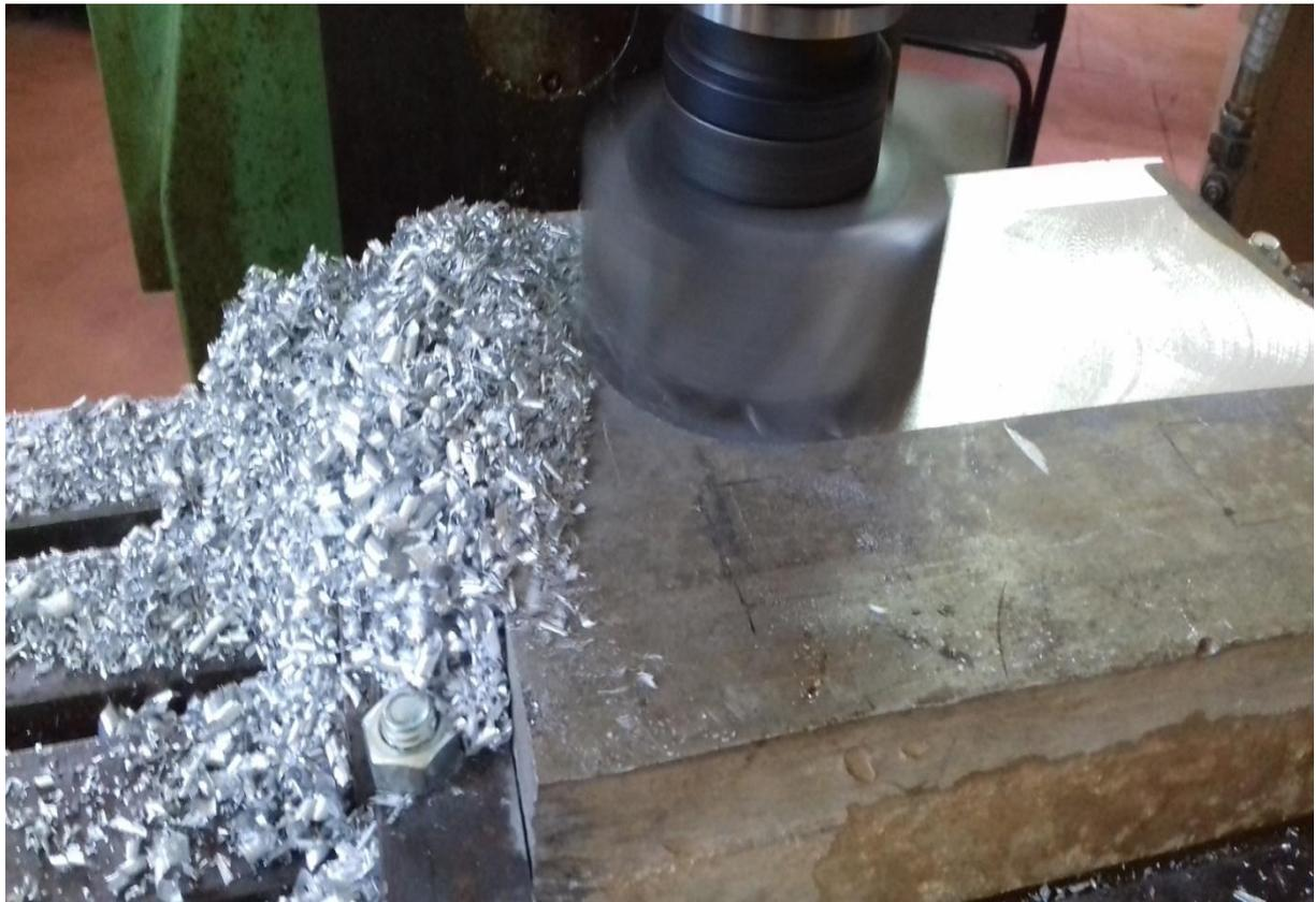
**Figure 4.16 : surfaçage du brut**
