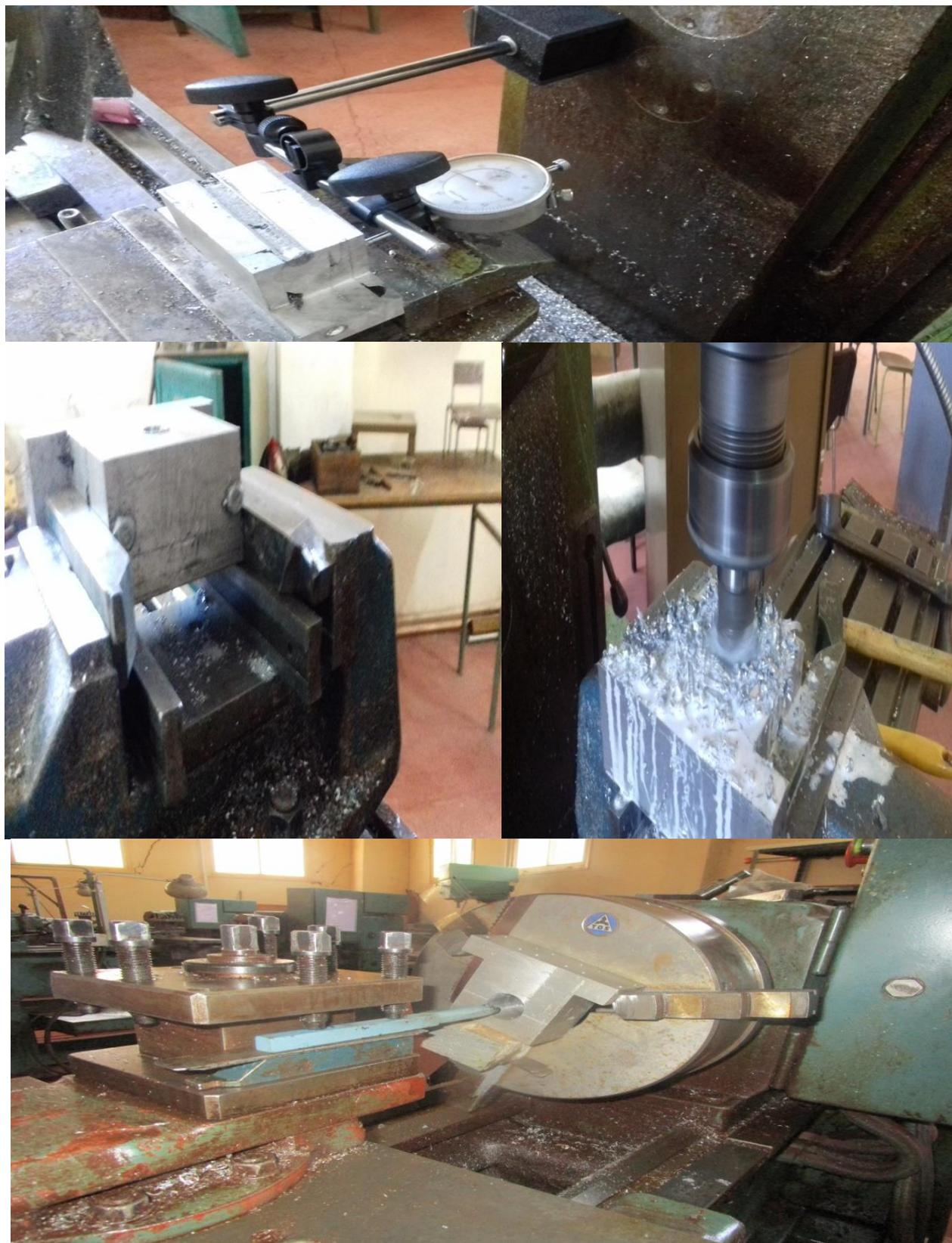
Figure 4.21 : usinage de support de la broche
