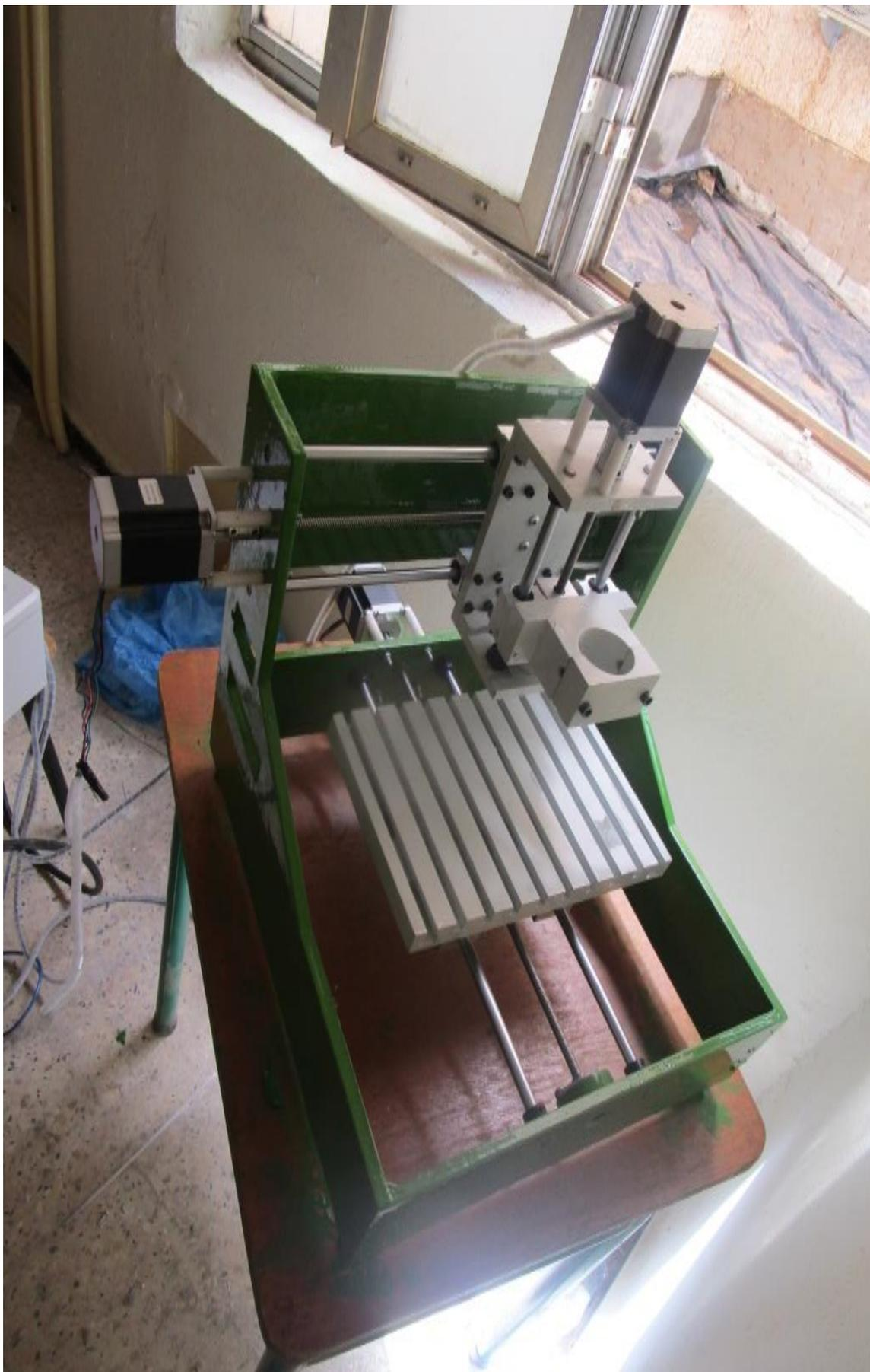
**Figure 4.23 : la mini fraiseuse CNC 3 axes**
