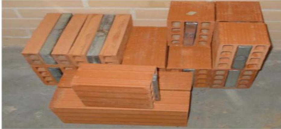
**Fig. 1.26. Intégration de MCP encapsulé dans des briques [37]**
