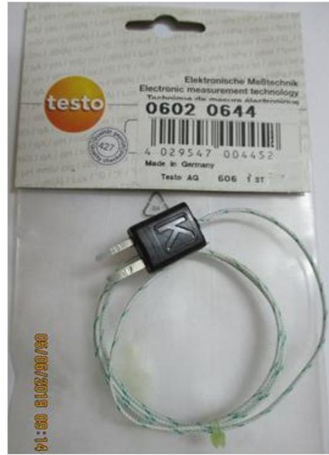
Fig. 3.9.d. Capteur de référence d'étalonnage
