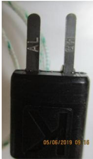
Fig. 3.9.c. Broches du capteur en cuivre Alumel
