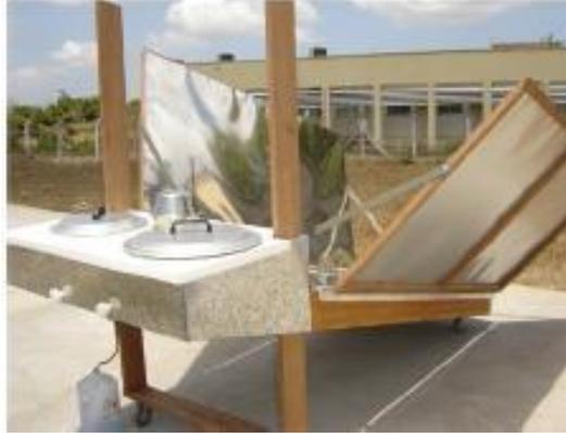
Figure II.11: Cuisson solaire indirecte avec capteurs plans vitrés [34].
