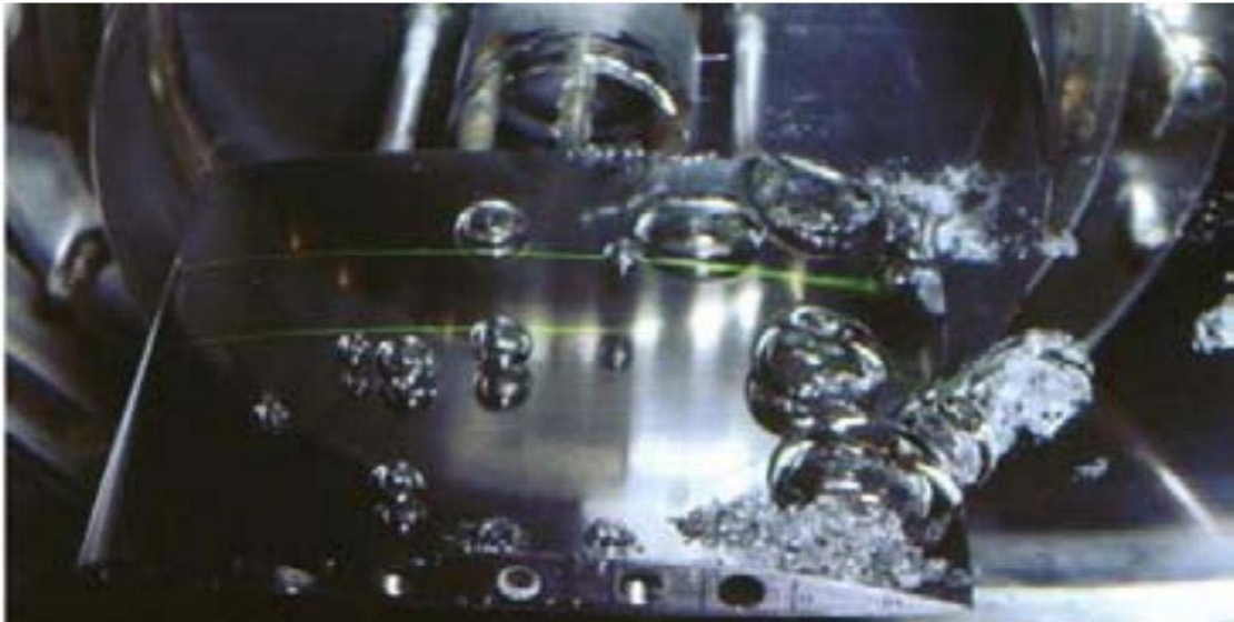
Figure I.7 : Cavitation par bulles isolées [4]
