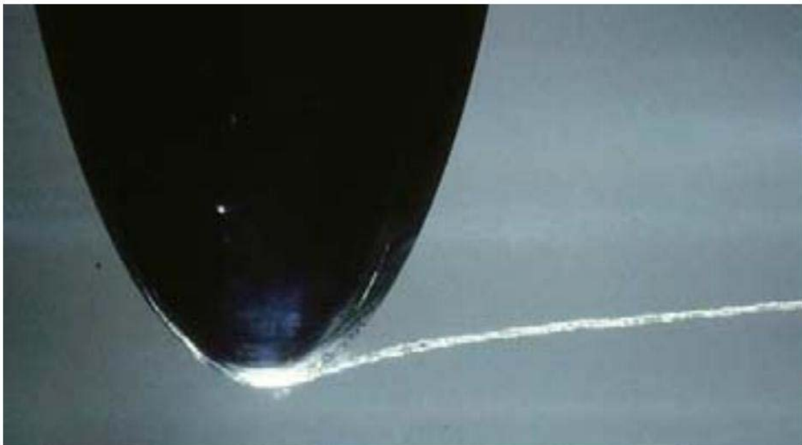
Figure I.8 : Cavitation par filaments tourbillonnaires [4]
