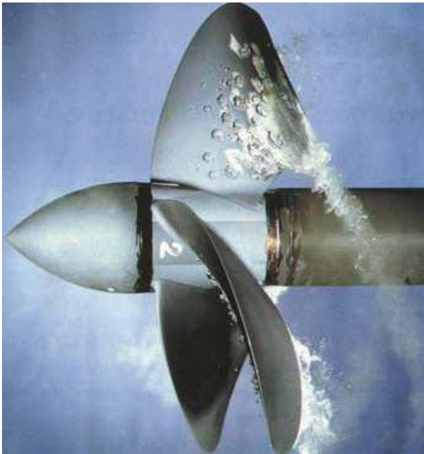
Figure I.10 : Apparition de bulles de cavitation sur les pales d'une hélice [5].
