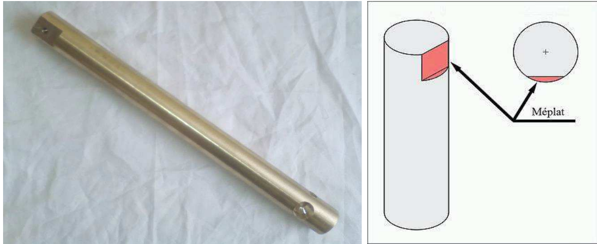
Figure II .15 Opération de méplat.
