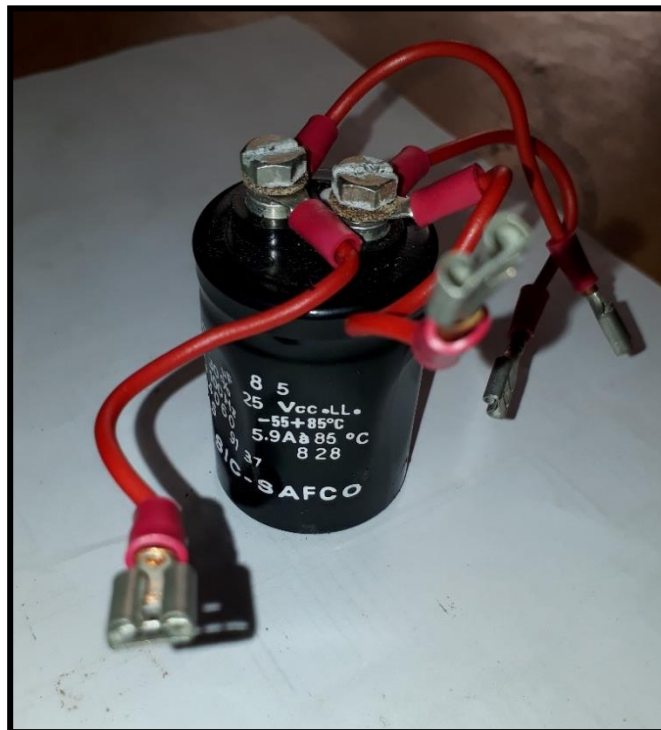
Figure4. 17 Condensateur après démontage
