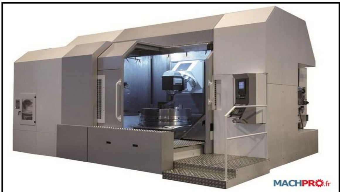
Figure 1.8 Centre de fraisage-tournage à 5 axes (HURON GRAFFENSTADEN UGV) [6]
