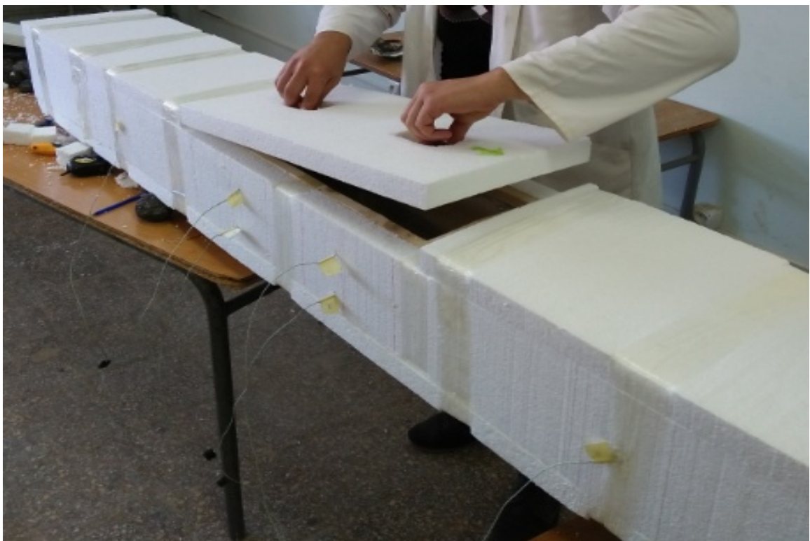
Fig. III.5. Isolation de canalisation.
