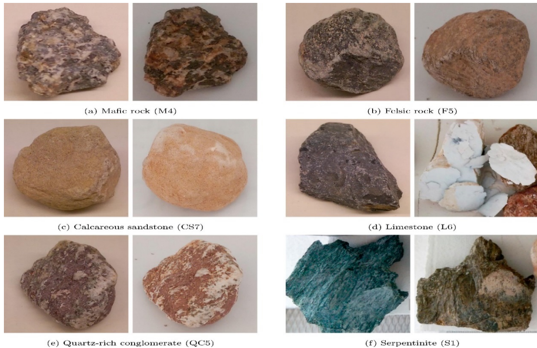
Fig. I.7. Échantillons de roche sélectionnés avant (à gauche) et après 20 cycles thermiques.
