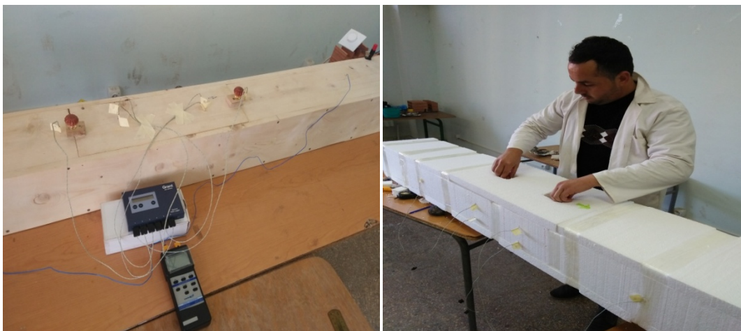
Fig. III.22. Banc d'essai sans et avec polystyrène
