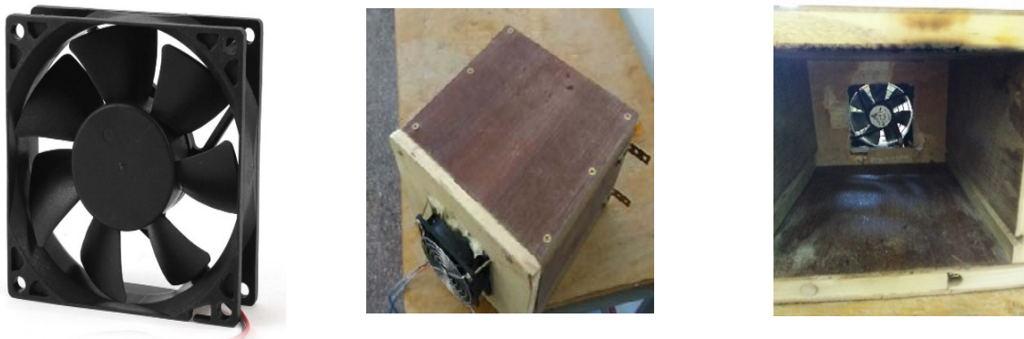
Fig. III.7. Ventilateur et son support en bois pour la circulation d'air.
