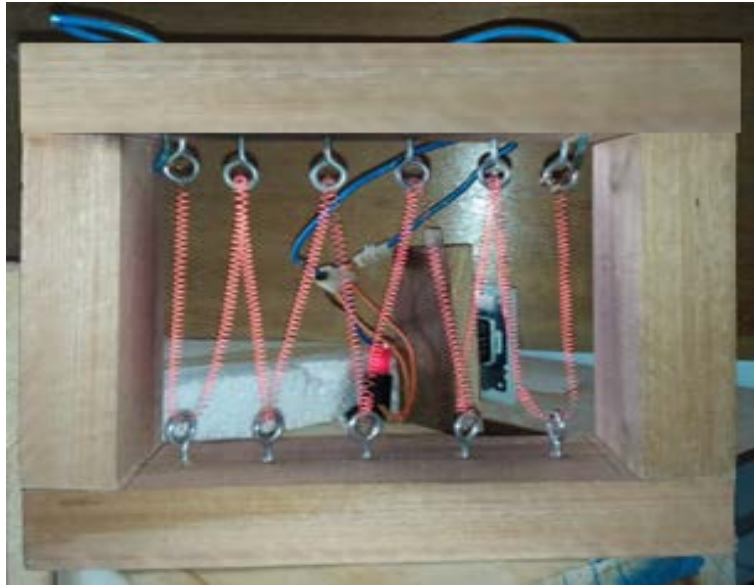
Fig. III.9. Résistance électrique chauffante.
