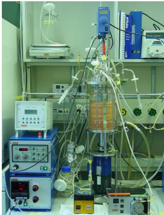
FIGURE 4.3 – Photo d'un simple chemostat dans un laboratoire [9]
