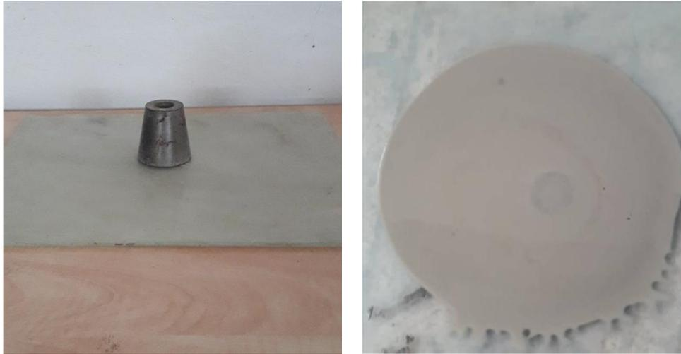
**Figure 3.3.** Essai d'étalement au mini-cône.
