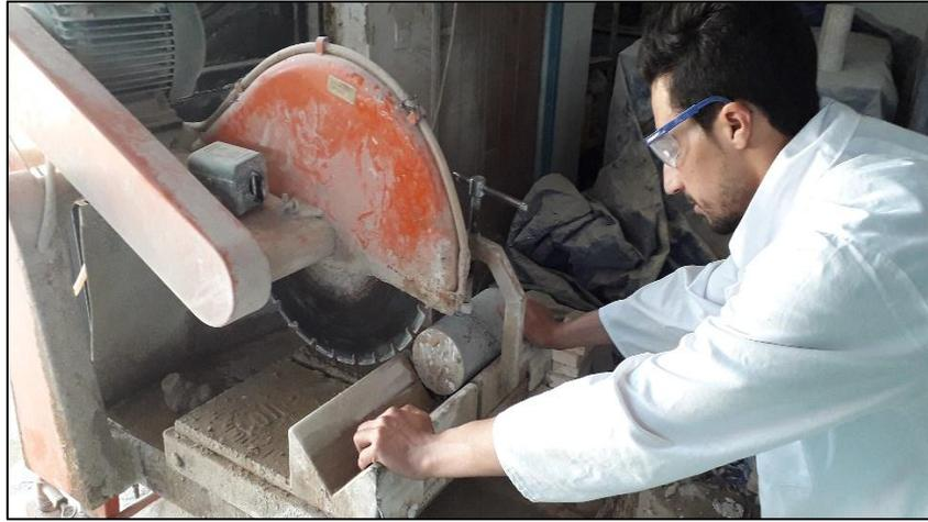
**Figure 3.14.** Rectification des surfaces des éprouvettes à l'aide de la scie à béton.
