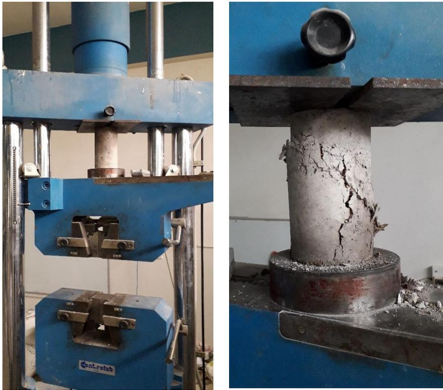
Figure 3.20 : Presse de capacité 600 KN.
