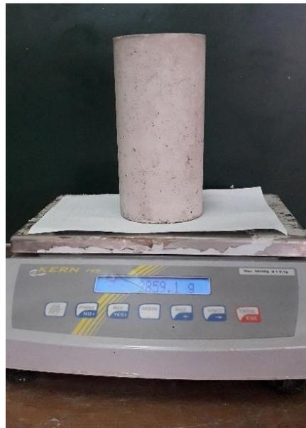
**Figure 3.16.** Essais de masse volumique des bétons.
