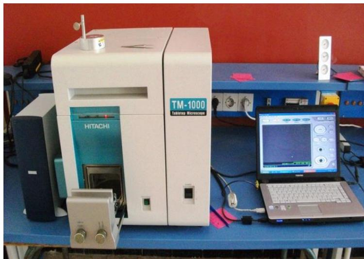
**Figure 3.23.** Analyse microscope électronique à balayage (MEB).
