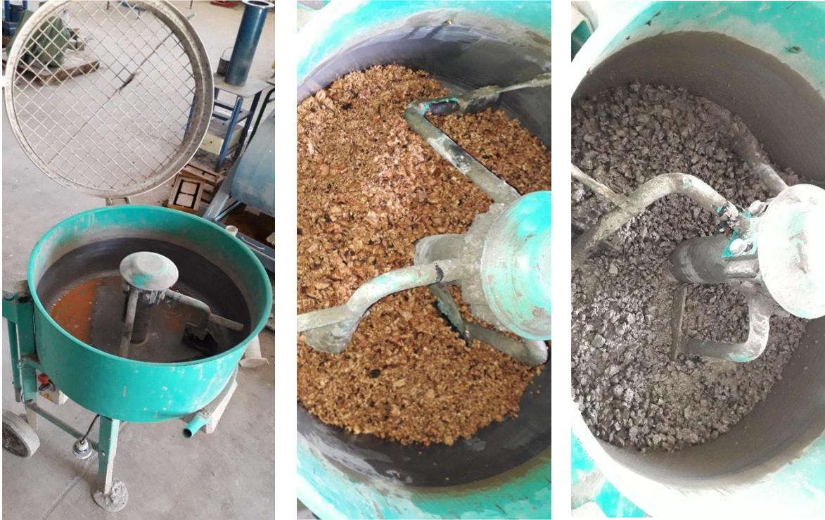
**Figure 3.12.** Malaxeur utilisé pour la formulation de bétons.
