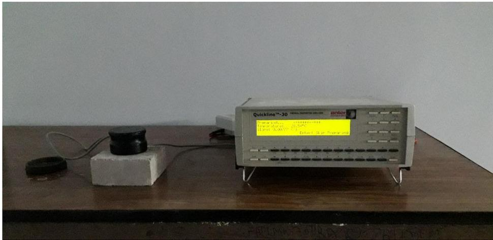
**Figure 3.22.** Essai de conductivité thermique.
