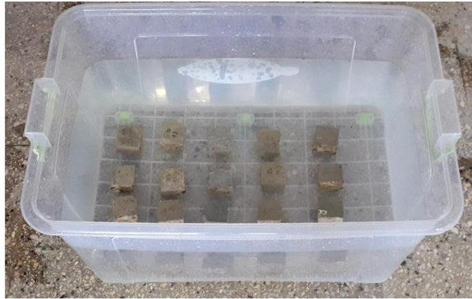
Fig 3.19. Immersion totale des échantillons dans l'eau.
