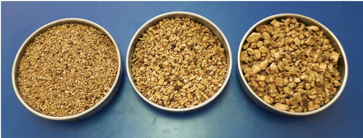
Figure 3.8. Les classes des granulats de liège utilisés.
