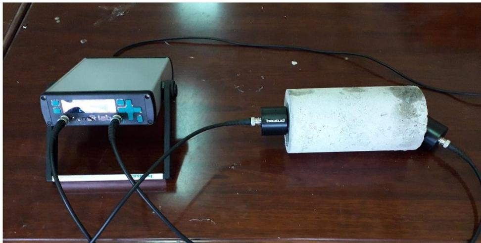
**Figure 3.18.** Essai à l'ultrason.
