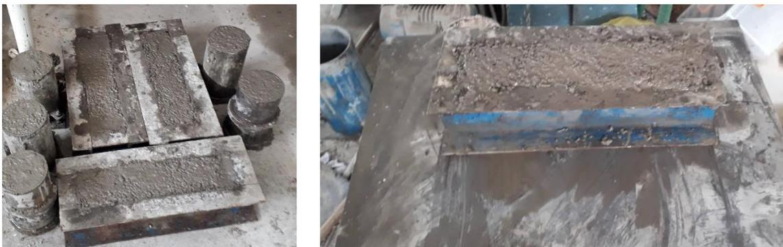
**Figure 3.13.** Table vibrante utilisée pour le serrage des échantillons de béton.
