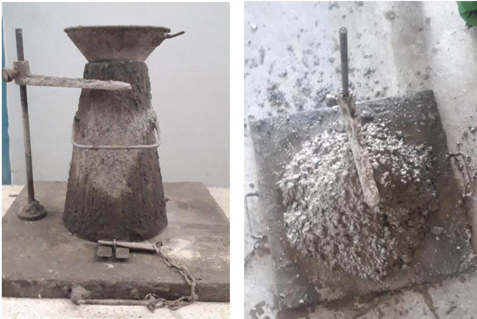
**Figure 3.15.** Essai d'affaissement au cône d'Abrams
