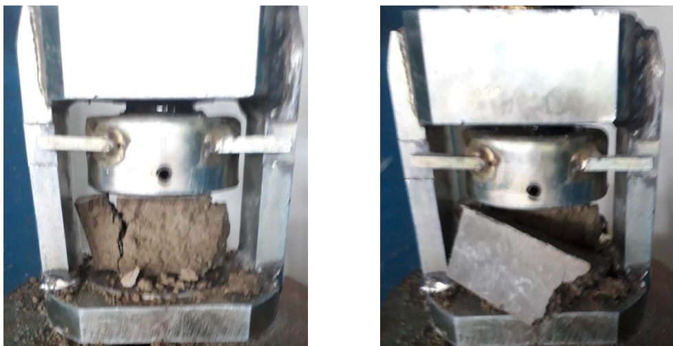
Figure III.5 : Essai de la résistance à la compression de l'échantillon contenant 1,2% d'extrait de feuilles de Henna.
