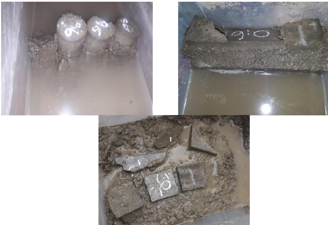
Figure III.1 : Détérioration de l'échantillon de mortier contenant 0,6 % d'Acide Ascorbique.
