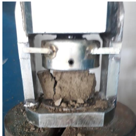
Figure II.2 : Ecrasement d'échantillon dans un essai de compression.
