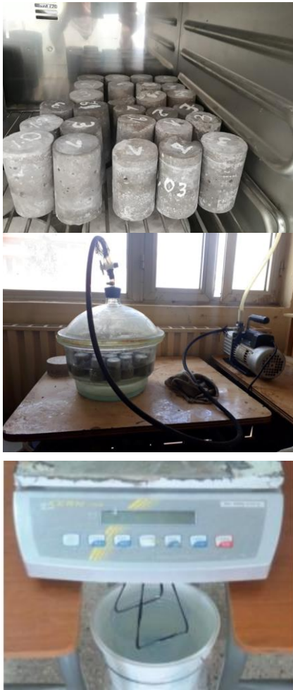
Figure II.5 : Les étapes à suivre pour la mesure de la porosité accessible à l'eau.
