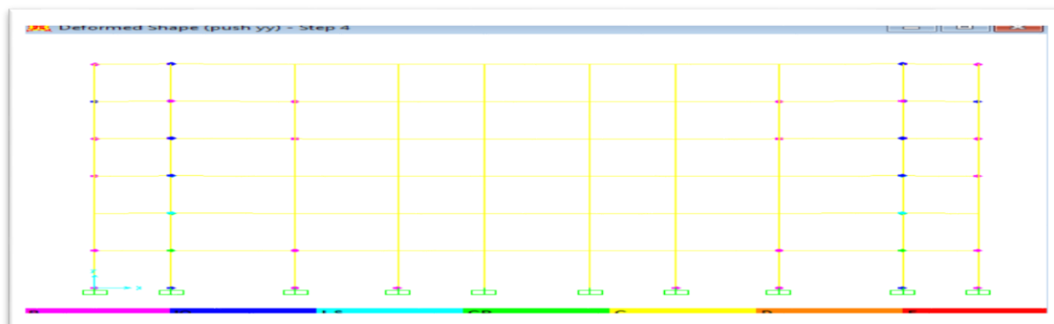
Figure 4.18 : Développement des rotules plastiques obtenues par SAP2000 sens X-Z
