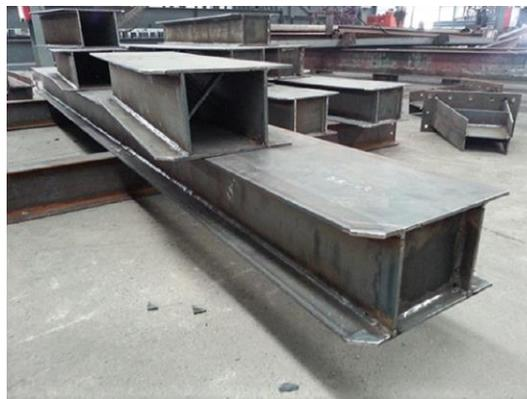
Figure I.34 : Poutre en PRS caisson
