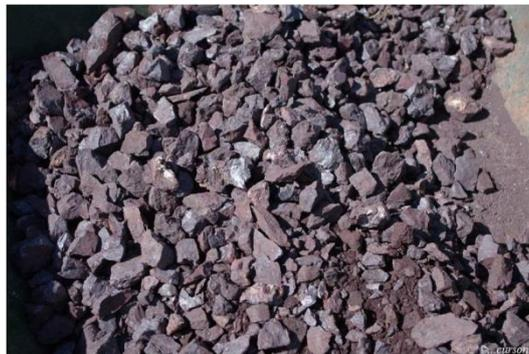
Figure I.1 : Minerai de fer (oxyde de fer)
