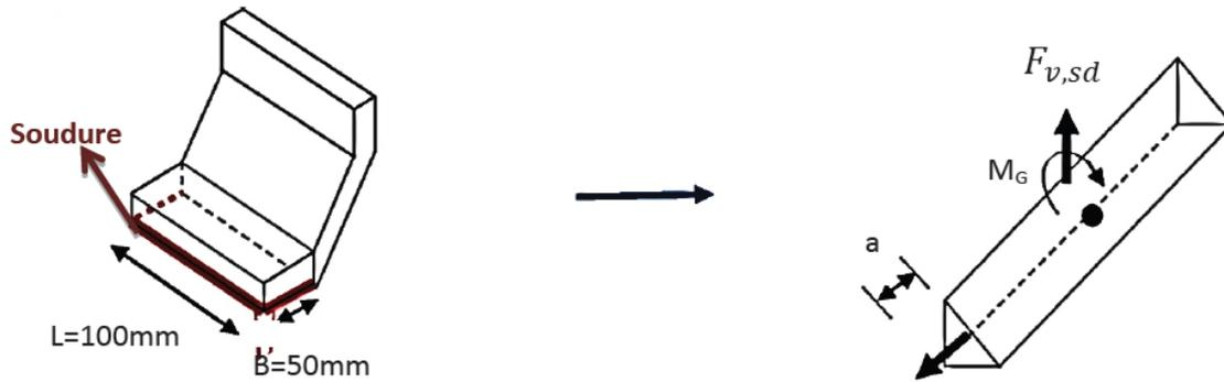
Figure IV.10 : Échantignole (soudure)
