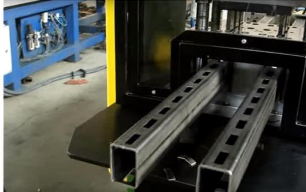
Figure I.19 : Poinçonnage de tube de sections rectangulaire
