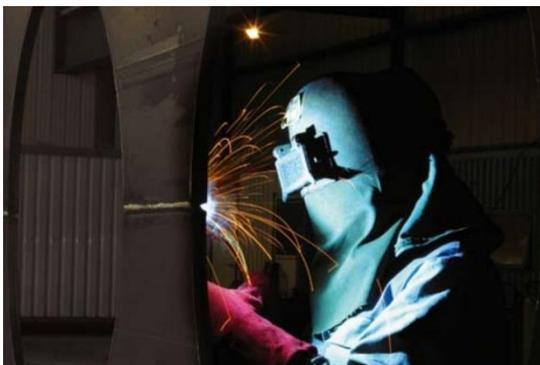
Figure I.23: Soudure avec électrodes manuelle profilés ajourés
