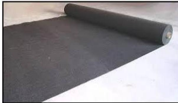
Figure 2-2 Nappe de géotextile (LCPC, 2003)
