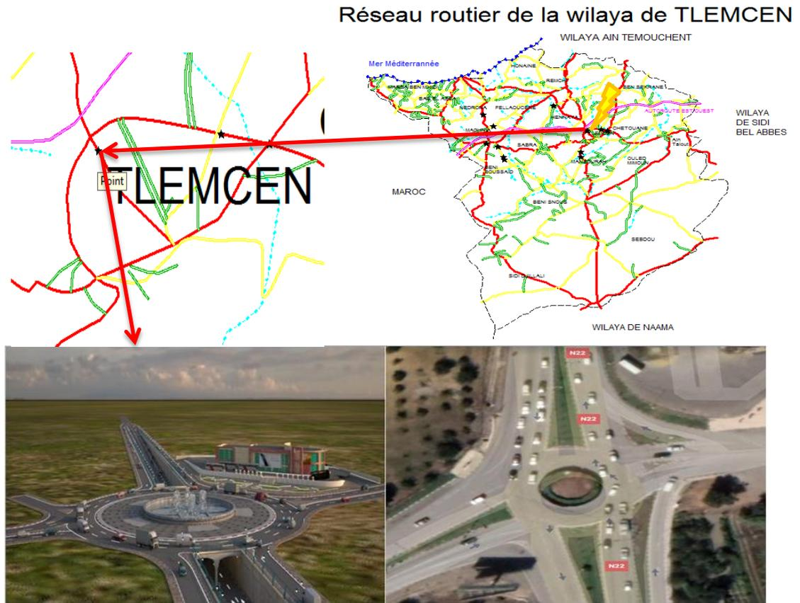
**Figure 4.19** Résolution proposée pour un point noir routier –carrefour de la nouvelle gare routière-
