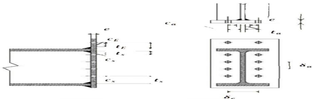
Figure II-1 : Configuration d'assemblage et notations utilisées
