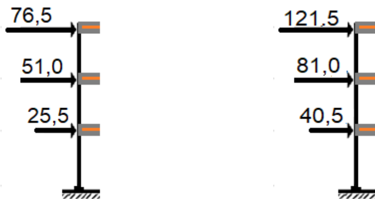
Figure 3.25 : Distribution des forces de ruines en prenant en compte les effet second ordre.
