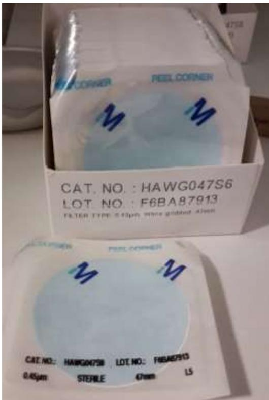
**Figure IV. 13 :** Les membrane filtrantes.
