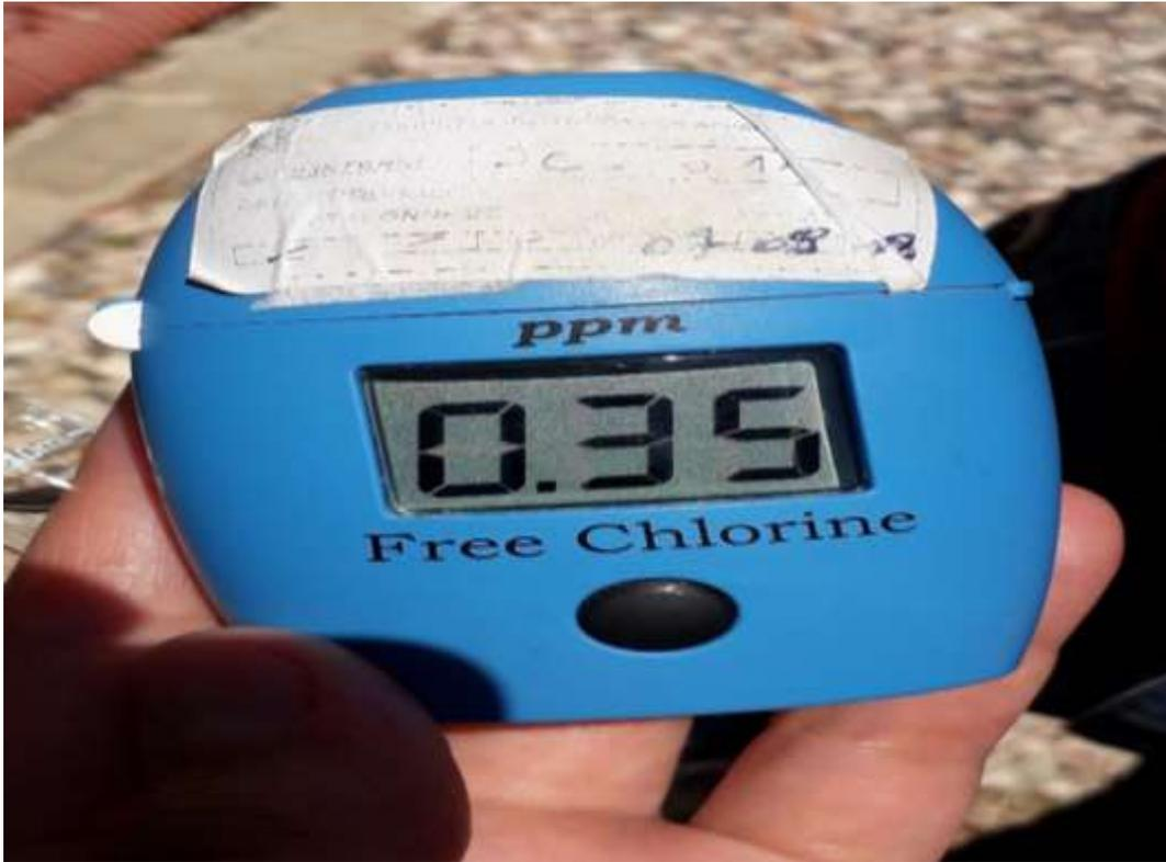
Figure IV. 11 : Chloromètre.
