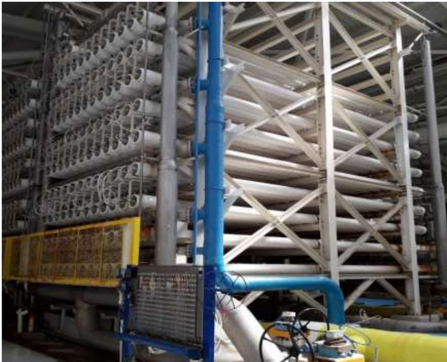
Figure III. 7 : Un châssis à membrane (châssis n°05).
