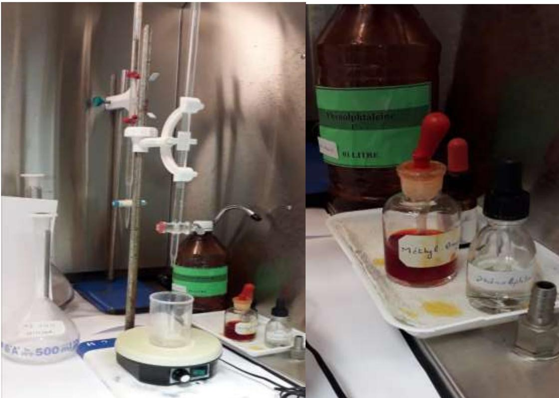
**Figure IV. 7 :** L'essai de titrage de l'alcalinité.
