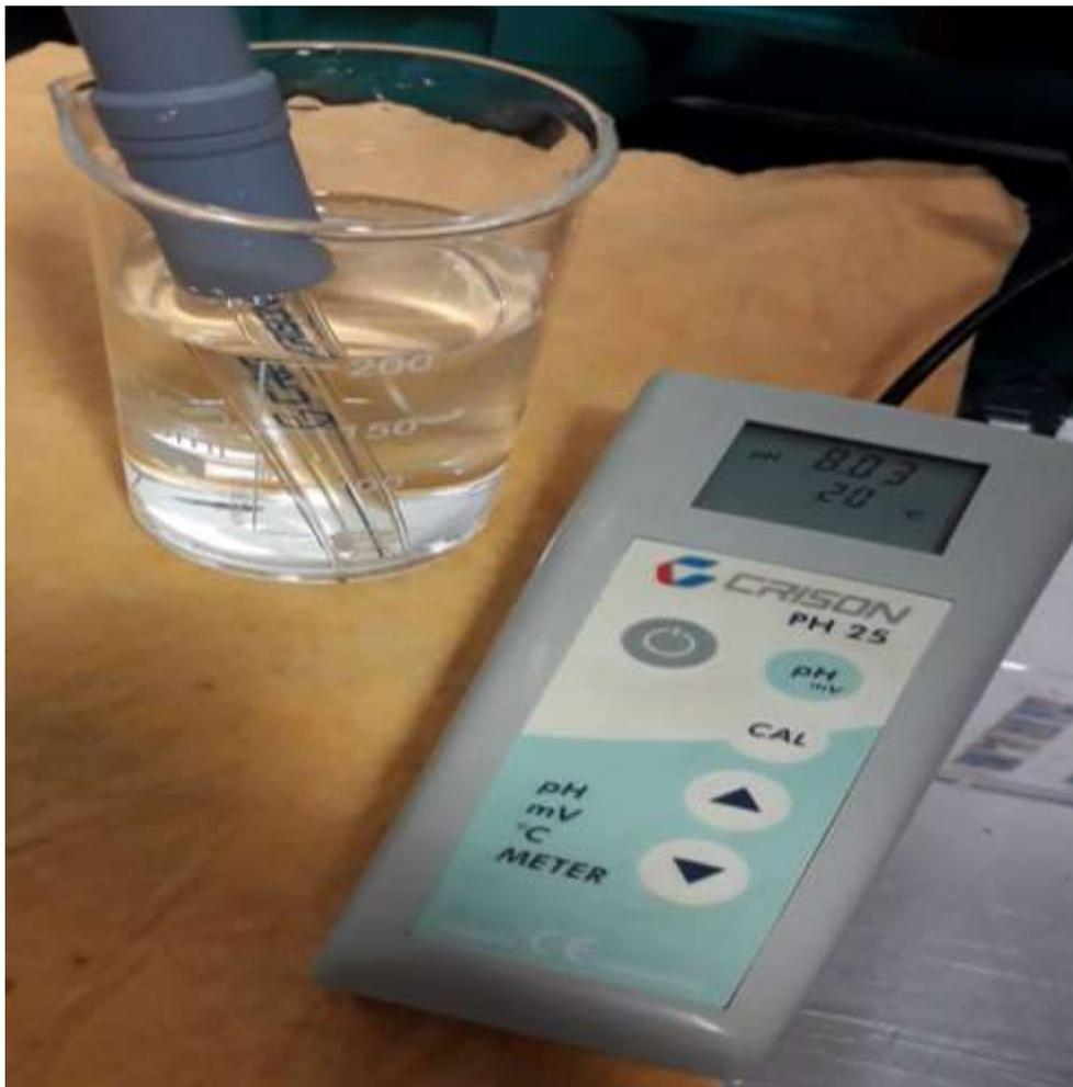
**Figure IV. 3 :** pH mètre (PH 25) au niveau de laboratoire de station de Honaine.
