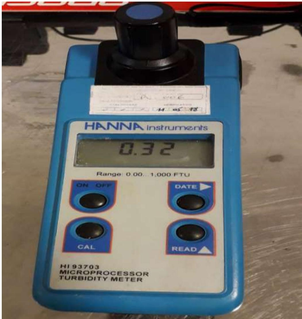
**Figure IV. 4 :** Turbidimètre.
