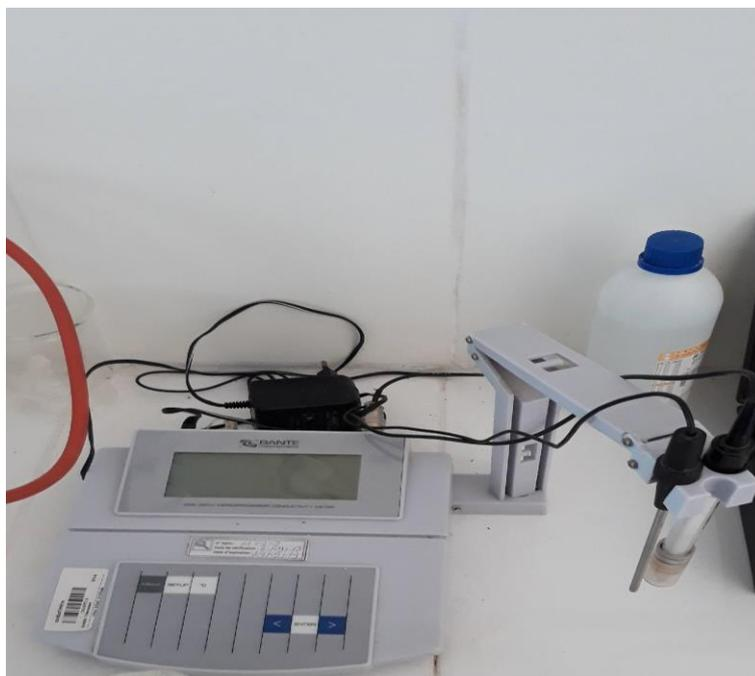
**Figure IV.2 :** Photo du conductivimètre.
