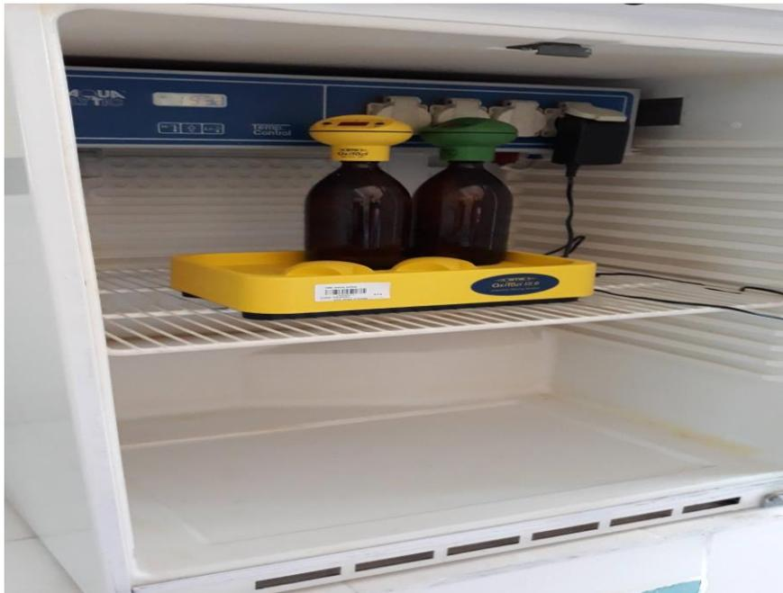
**Figure IV.8 : DBO mètre.**
