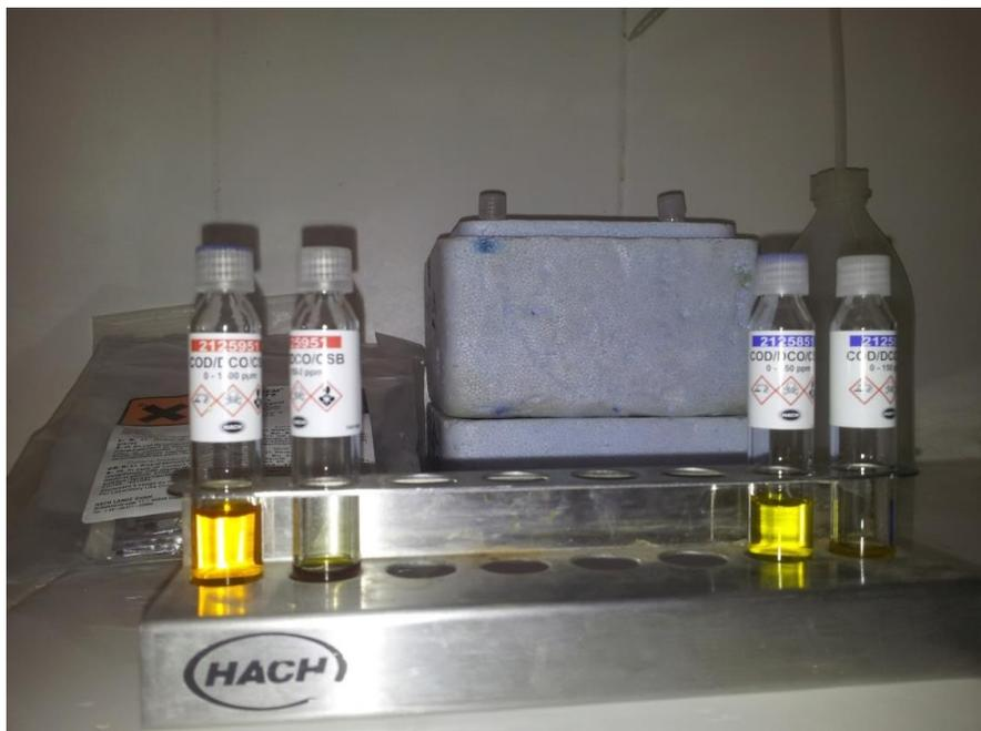
**Figure IV.6 : Photo du réactif à DCO.**
