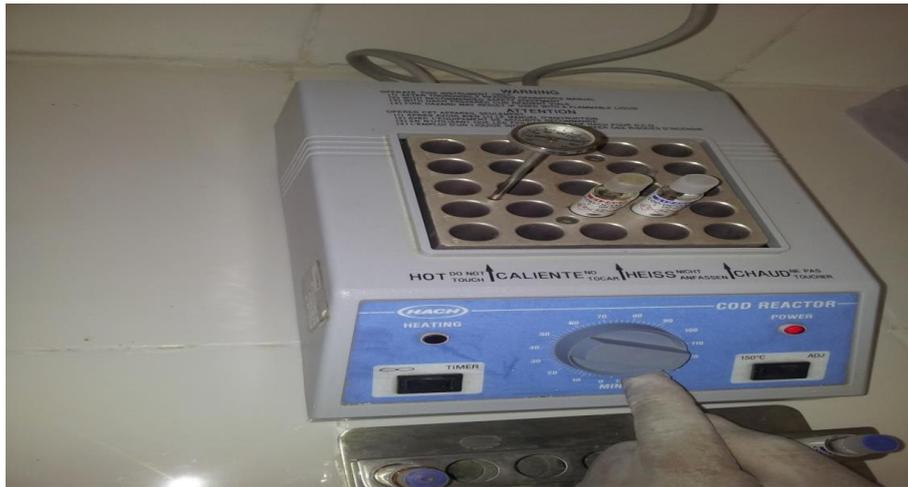
Figure IV.7 : Photo du réacteur DCO mètre.
