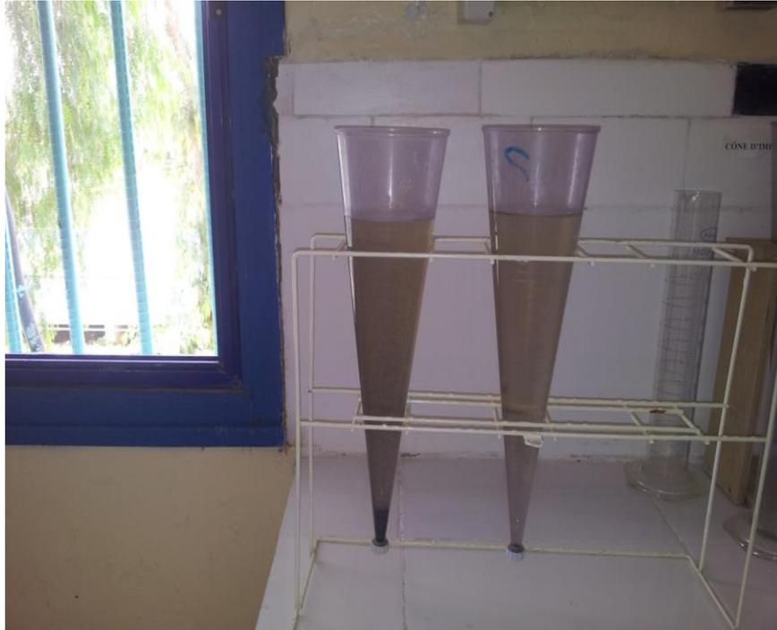
**Figure IV.4 :** Photo de Cônes d'IMHOFF.
