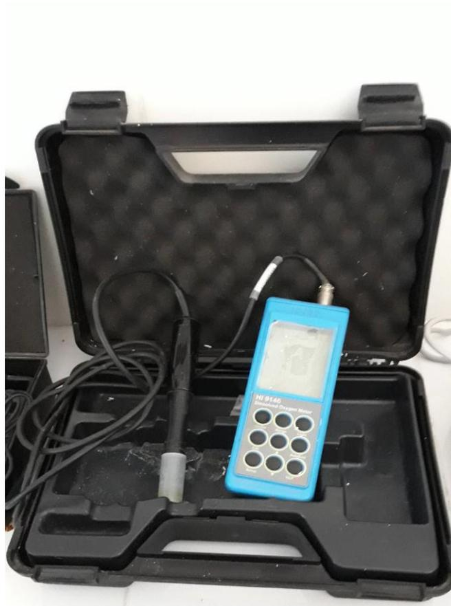
**Figure IV.3 :** Photo d'un Oxymétrie portatif (HI 9146).
